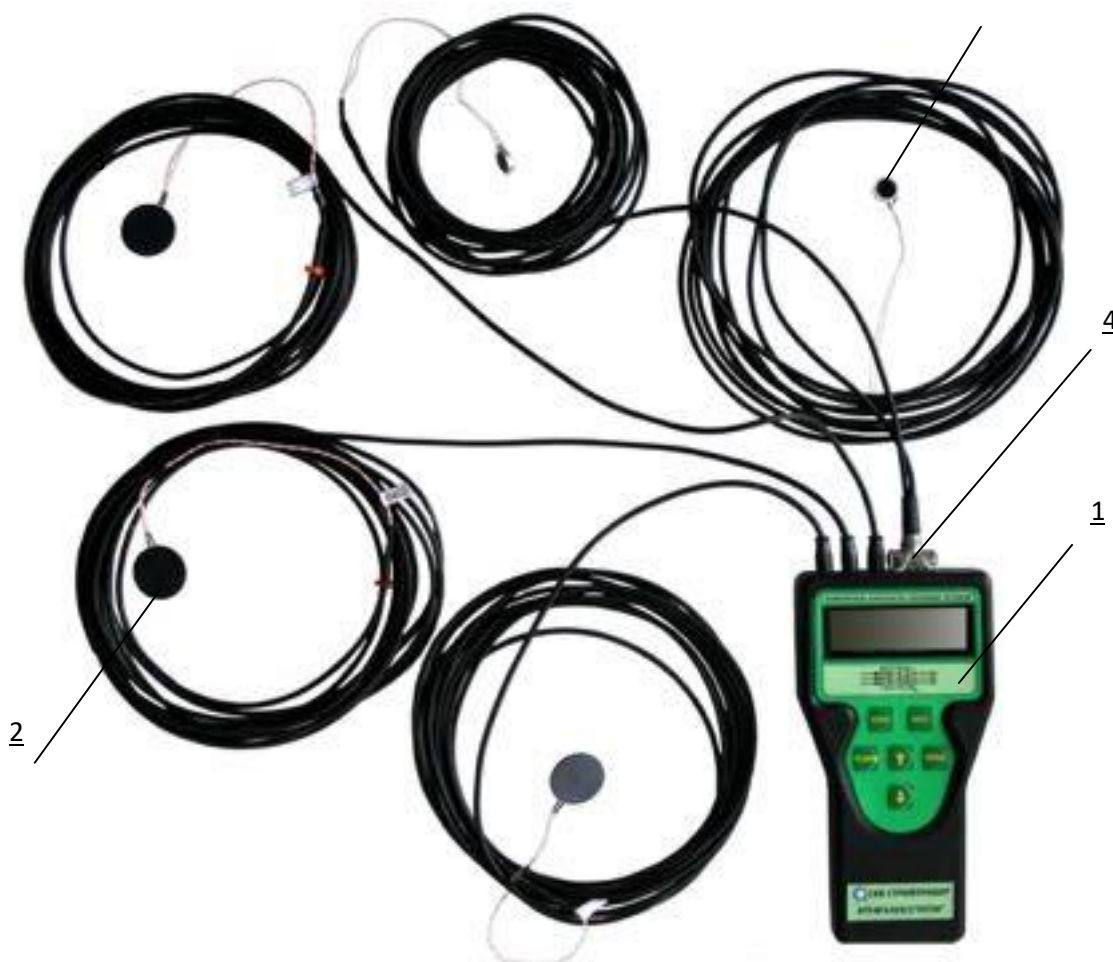
Рисунок 3.2. Внешний вид измерителя плотности теплового потока и температуры ИТП-МГ4.03/5(III) «Поток»:
