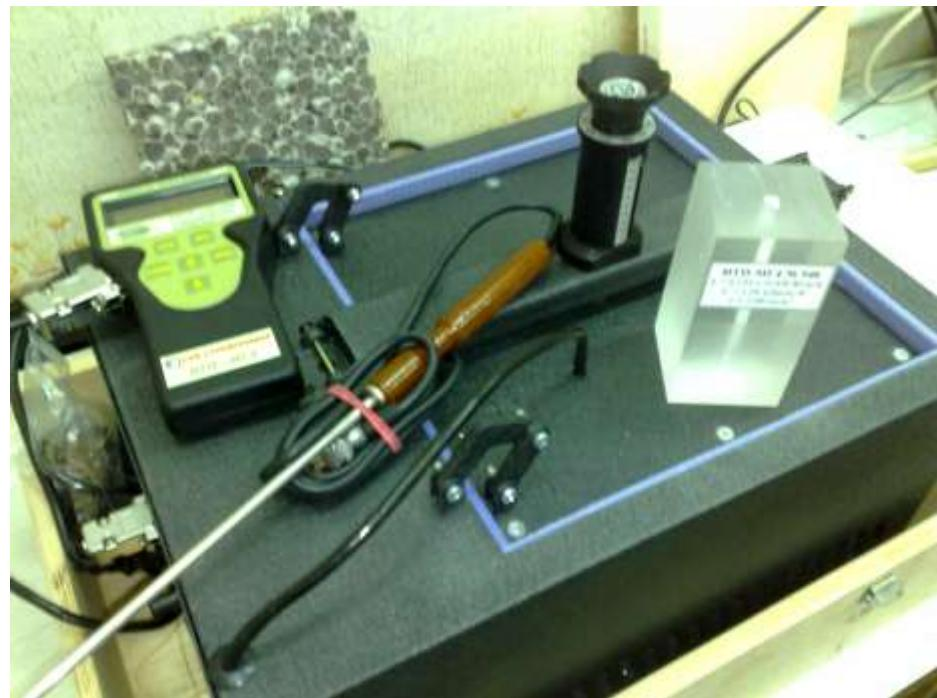
Рисунок 3.1. Измеритель теплопроводности ИТП-МГ 4 «250»
