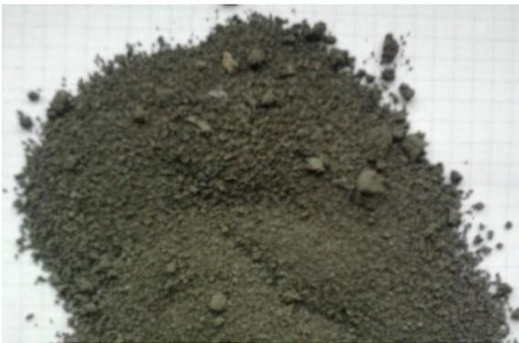
Рисунок 3.20 – Структура осадка после воздействия отрицательных температур
