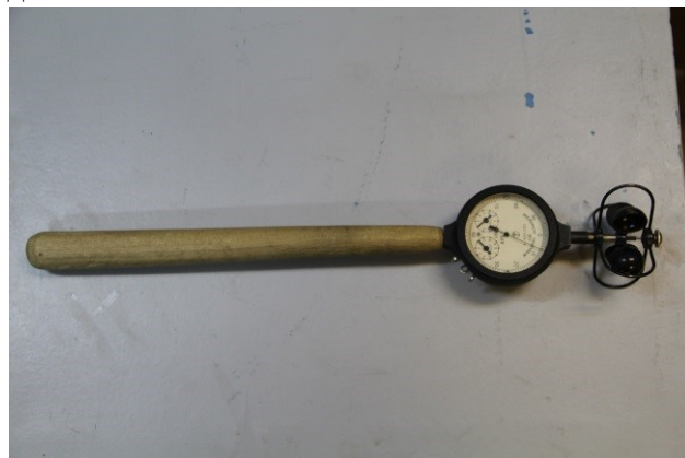
Рисунок А.4 – Оборудование для аэродинамических испытаний: а, б, в – аэродинамическая труба; г – микроманометры ММН-240 (5)-1,0; д – чашечный анемометр МС-13
