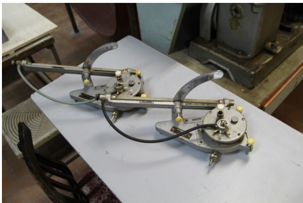
Рисунок А.4 – Оборудование для аэродинамических испытаний: а, б, в – аэродинамическая труба; г – микроманометры ММН-240 (5)-1,0; д – чашечный анемометр МС-13
