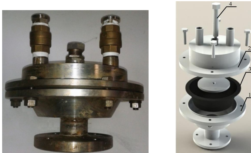
1, 2 – детали корпуса; 3 – эластичная диафрагма; 4 – регулировочный винт
