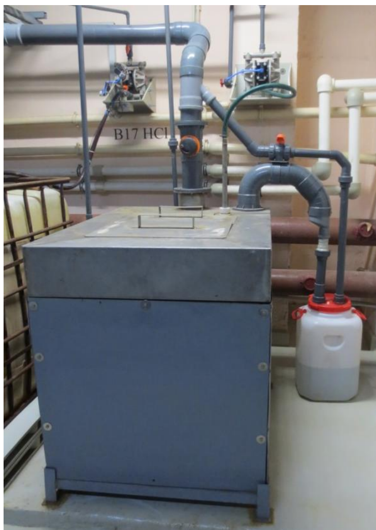
Рисунок 5.4. Общий вид реактора для предварительной очистки высококонцентрированных отработанных медно-аммиачных травильных растворов и абсорбера.
