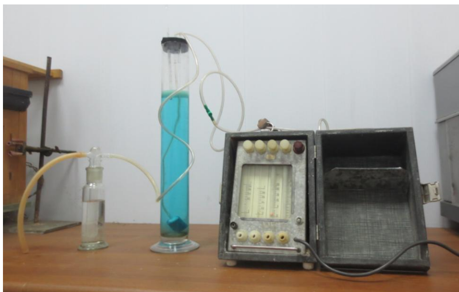
Рисунок 4.2. Общий вид лабораторной установки для исследований процесса отдувки аммиака.
