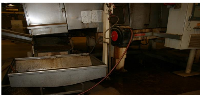
в) – Ёмкость для смыва остаточных компонентов, образующихся в результате расщепления табачной жилки;
