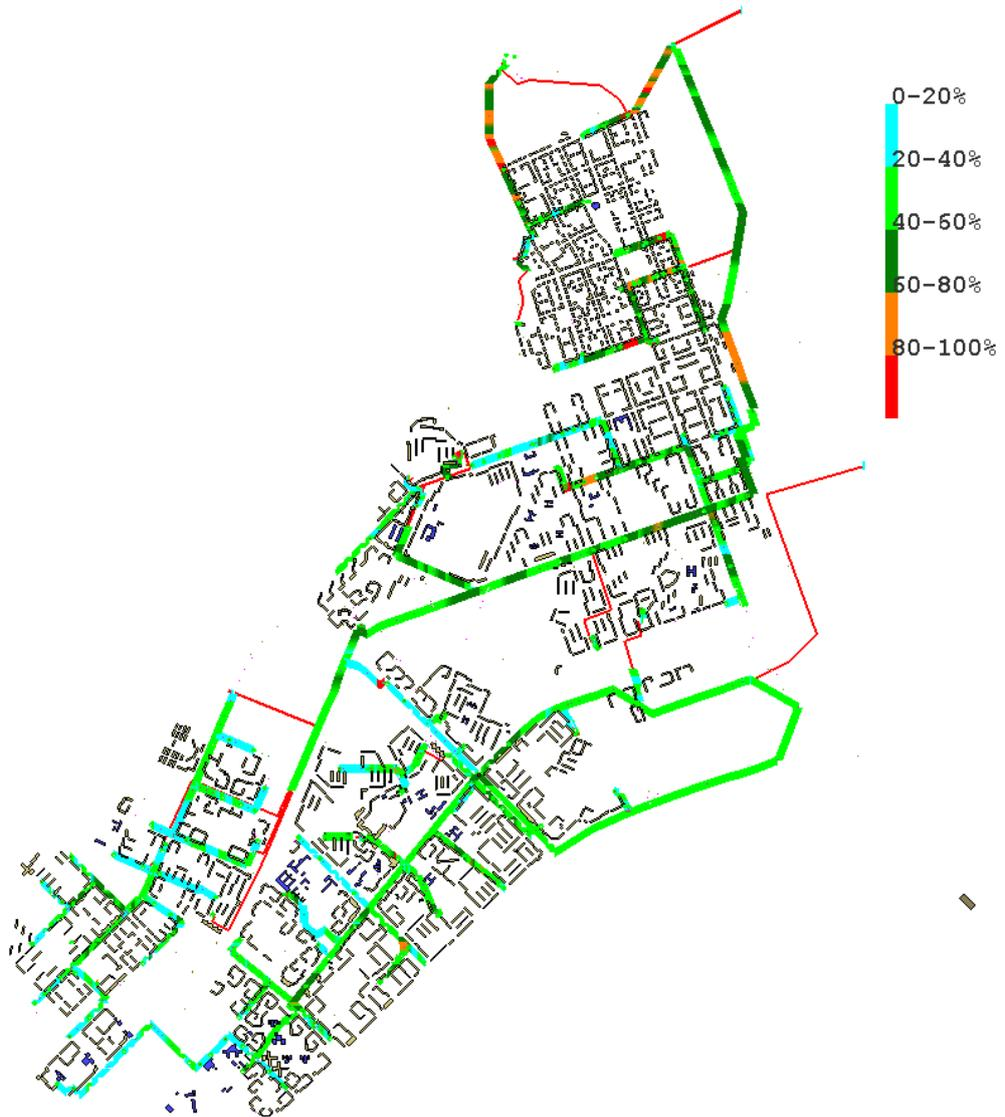
Рисунок 7.14 - Карта распределения потоков и заполненности коллекторов
