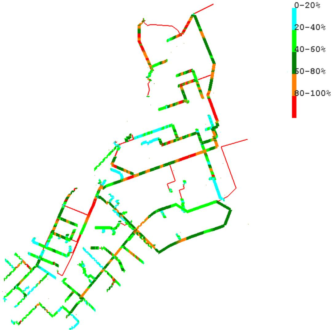
Рисунок 7.16 - Карта распределения потоков и наполненности коллекторов с учетом перспективных нагрузок
