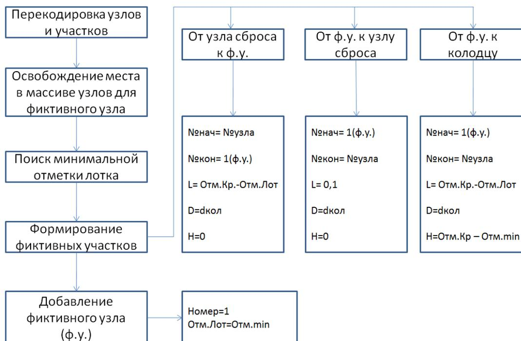
Рисунок 7.2 – Перекодировка данных и формирование расчетной схемы
