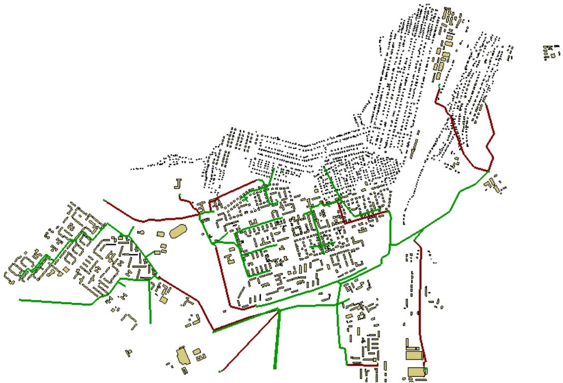
Рисунок 7.27 – Существующая система водоотведения г. Шелехов
