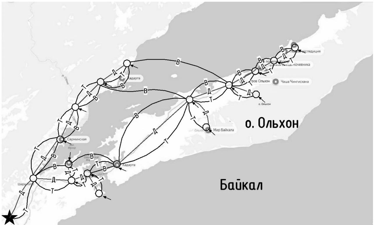
Рисунок 10 – Избыточная схема на основе проектных вариантов водоотведения (в - водный транспорт, д – автомобильный, т – трубопроводный)
