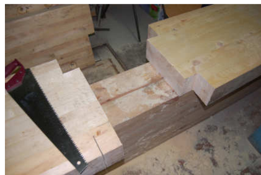
Рисунок 4.6 – Вырез «четвертей» под соединительный сварной элемент
