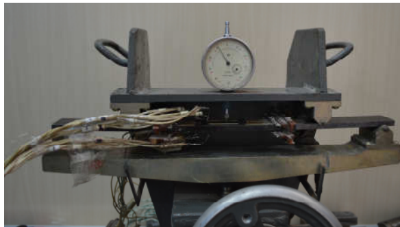
Рисунок 4.28 - Общий вид установки для тарирования тензорезисторов
