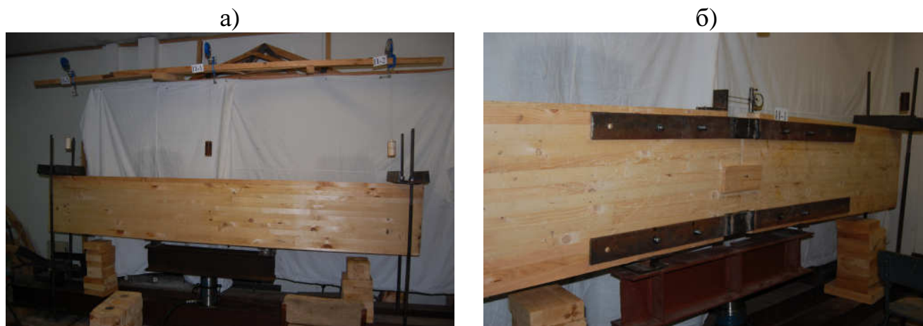
а - испытание цельной балки, б - испытание жёсткого узла балки с применением вклеенных стальных шайб
