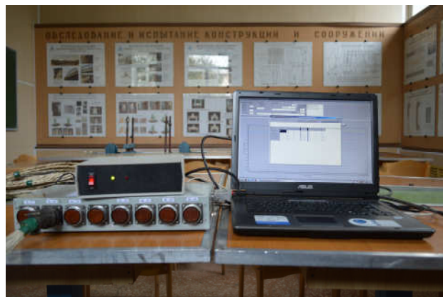
Рисунок 4.27 - Общий вид тензометрической системы ММТС.64-01
