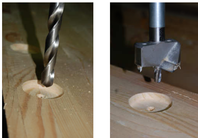
Рисунок 4.7 - Сверление отверстий под шайбы и стяжные болты
