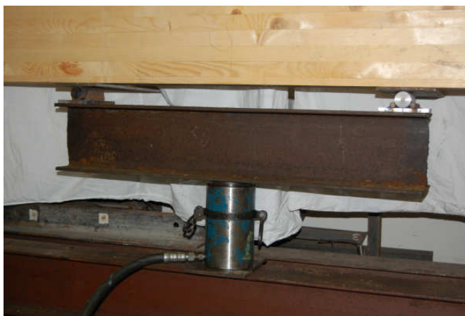
Рисунок 4.11 - Схема приложения нагрузки на клеёную балку
