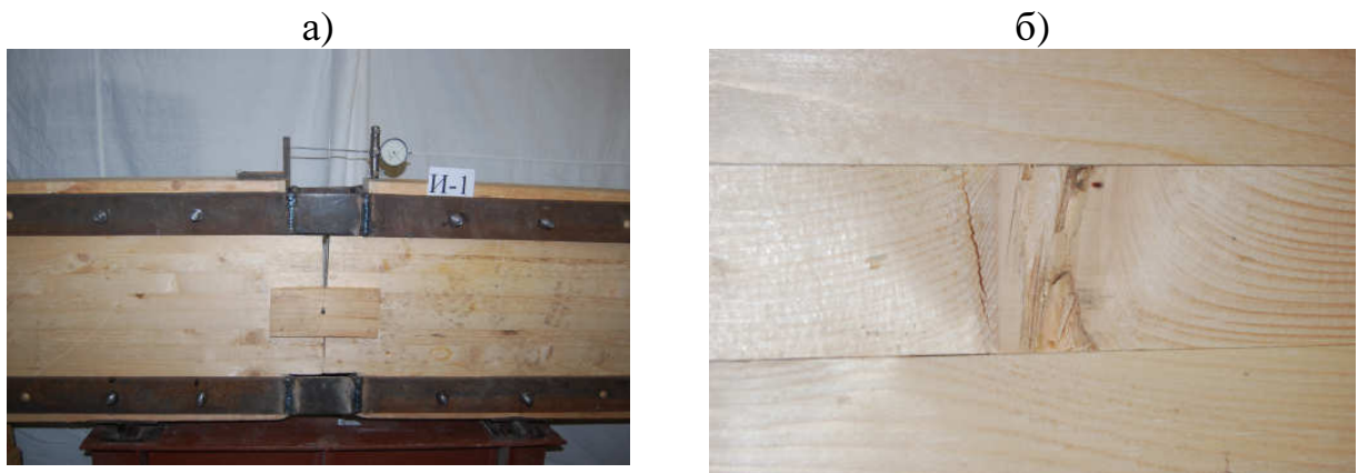
а - деформация балки под нагрузкой, б - нормальная трещина поперёк волокон балки
