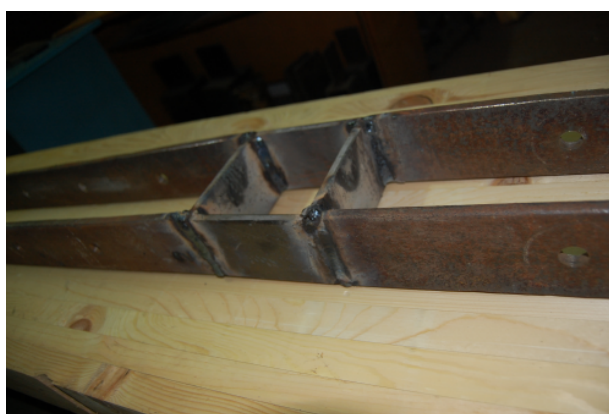
Рисунок 4.10 - Соединительный сварной элемент для стыка клеёной балки
