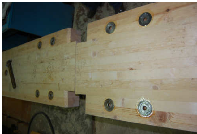
Рисунок 4.9 - Образцы стыка клеёной балки с вклеенными шайбами
