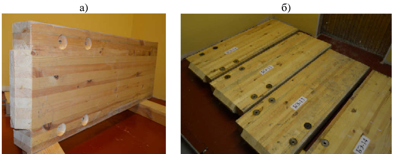
а - с отверстиями и гнёздами под шайбы, б - с вклеенными шайбами
