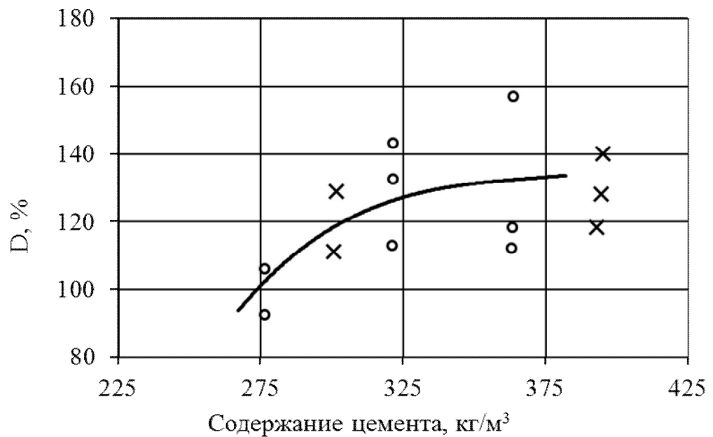
Рис. 2.3. Зависимость D бетона молодого возраста от содержания цемента. В/Ц = 0,64. Экспериментальные точки (слева направо) соответствуют составу бетона соответственно 1:2,1:4,9; 1:1,62:3,92; 1:1,4:3,27. (Значения D даны в процентах от средних значений, соответствующих содержанию цемента, равному 275 кг/м³)
