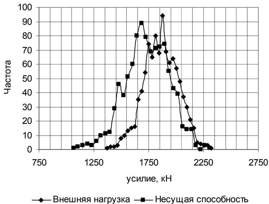
Рис 5.19 Полигон распределения экспериментальных частот при \mu=0.196\%
