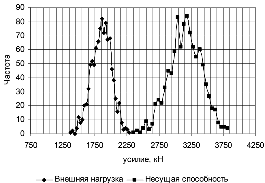
Рис 5.24 Полигон распределения экспериментальных частот при \mu=2.545\% (Арматура 4\varnothing 36 АIII надежность P=1,000 )
