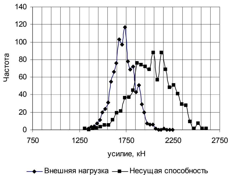
Рис 5.22 Полигон распределения экспериментальных частот при \mu=0.95\% (Арматура 4\varnothing 22 АIII надежность P=0,932 )
