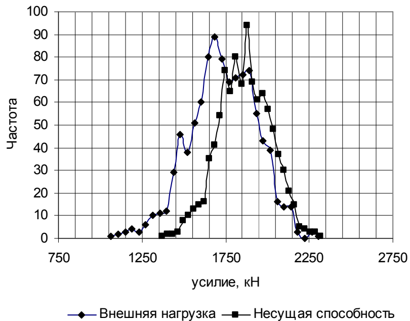
Рис 5.21 Полигон распределения экспериментальных частот при \mu=0.636\% (Арматура 4\varnothing 18 АIII надежность P=0,755 )
