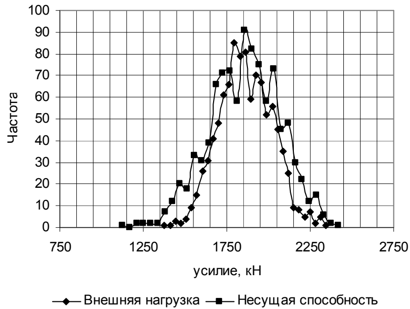
Рис 5.20 Полигон распределения экспериментальных частот при \mu=0.385\% (Арматура 4\varnothing 14 АIII надежность P=0,507 )
