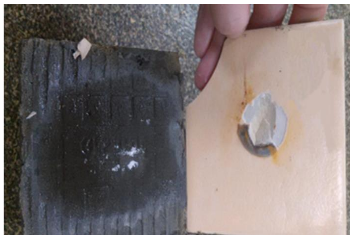
Рисунок 5.6 – Прочность сцепления плиточного клея с цементно-песчаной подложкой и керамической плиткой после выдерживания в водной среде
