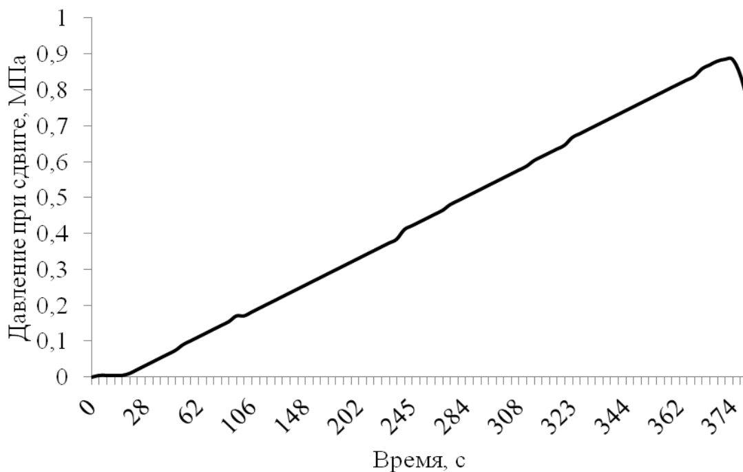
Рисунок 5.3 – Испытание на сдвиг плиточного клея на цементной основе
