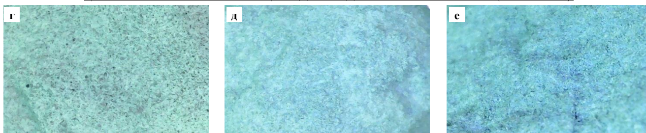
Рисунок 5 – Сколы образцов цементного камня (увеличение \times 56 ): а, г – НВТ; б, д – 800 °С; в, е – 1200 °С
