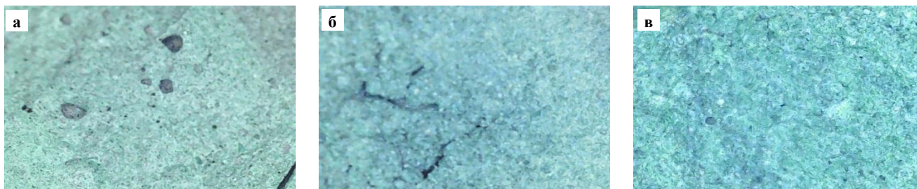
Цементный камень на основе ПЦ 500-Д0 + ТОД ИМ2201 + наполнитель (10 % шлама)
