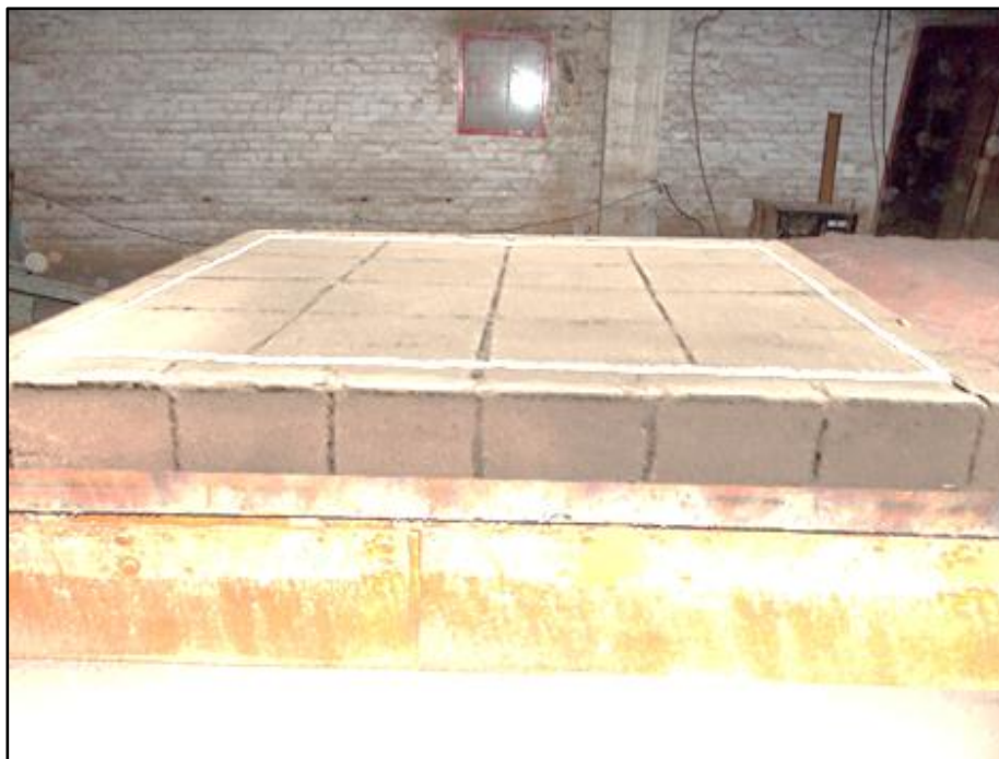
Рисунок 5.2 – Сборно-монолитная футеровка печной вагонетки
