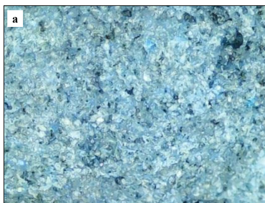
Рисунок 4.11 – Сколы образцов шамот-силикат-натриевых композиций на основе силикат-глыбы (увеличение \times 64 ): а – контрольный состав; б – состав с добавкой 10 % шлама ЦТА
