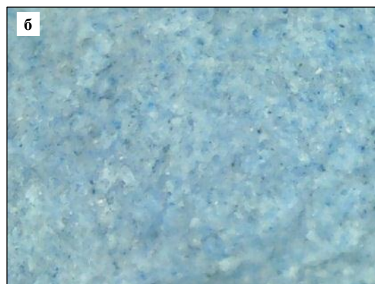
Рисунок 4.12 – Сколы образцов муллит-силикат-натриевых композиций на основе силикат-глыбы (увеличение \times 64 ): а – контрольный состав; б – состав с добавкой 10 % шлама ЦТА
