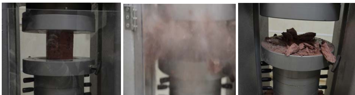
Рис. 8 Испытание образца-куба с ребром 100 мм окрашенного порошково-активированного песчаного бетона после 1000 циклов замораживания-оттаивания при предельной нагрузке 162 т
