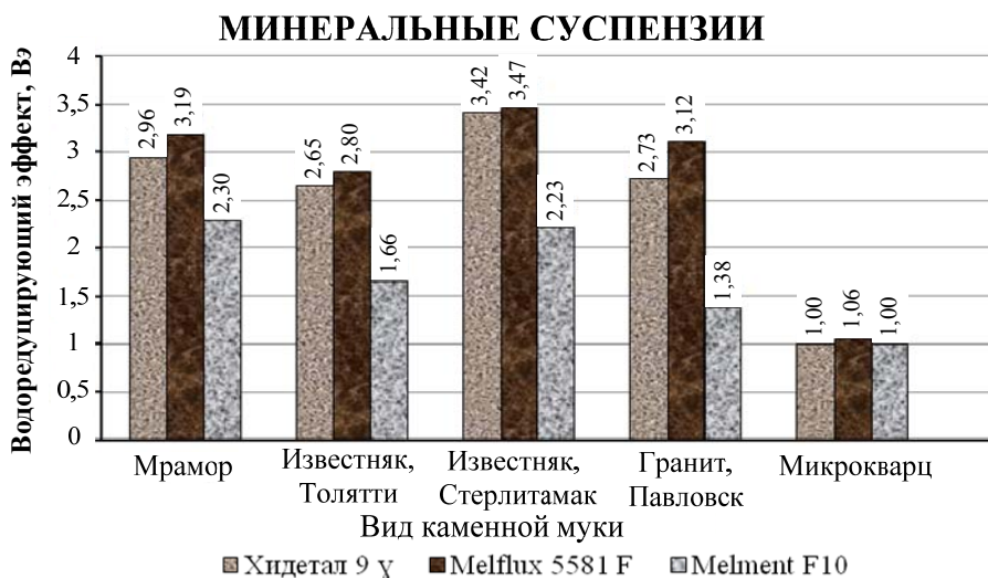
Рис. 3 Значения водоредуцирующих эффектов индивидуальных цементных суспензий, минеральных суспензий, суспензий минеральных пигментов и бинарных цементно-минеральных суспензий с различными пластификаторами
