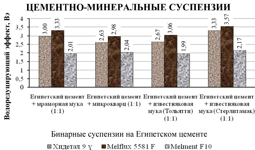
Рис. 3 Значения водоредуцирующих эффектов индивидуальных цементных суспензий, минеральных суспензий, суспензий минеральных пигментов и бинарных цементно-минеральных суспензий с различными пластификаторами
