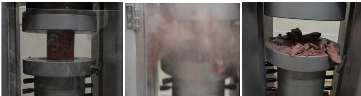
Рис. 8 Испытание образца-куба с ребром 100 мм окрашенного порошково-активированного песчаного бетона после 1000 циклов замораживания-оттаивания при предельной нагрузке 162 т
