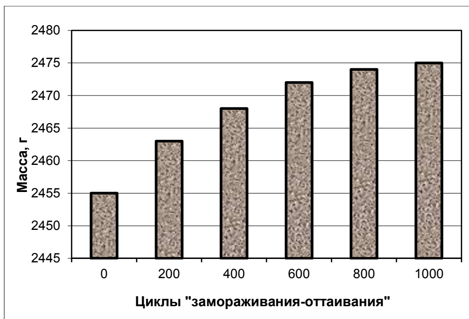
Рис.5.22 Изменение массы образца в зависимости от увеличения количества циклов «замораживания-оттаивания»
