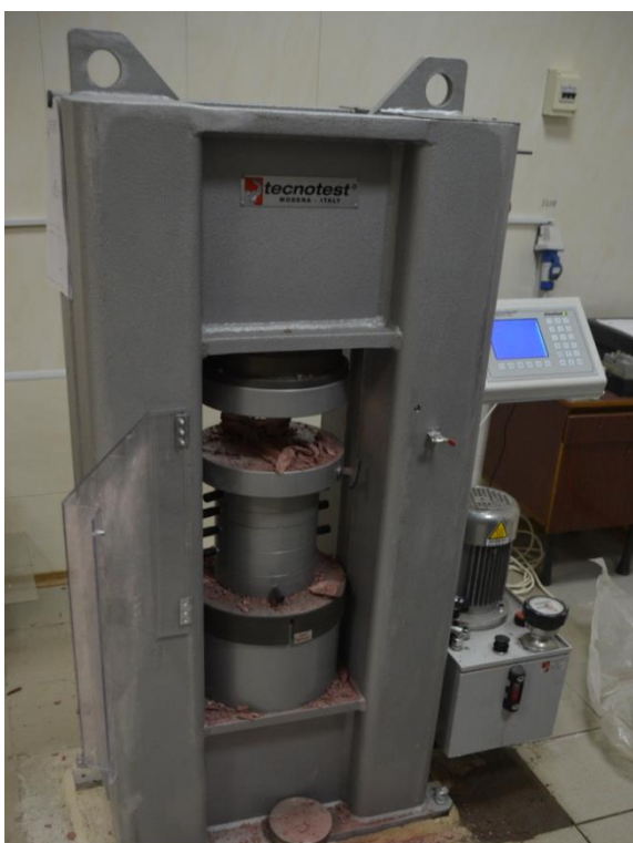
Рис. 2.1 Вид пресса «Tecnotest» при испытании образца окрашенного порошково-активированного песчаного бетона
