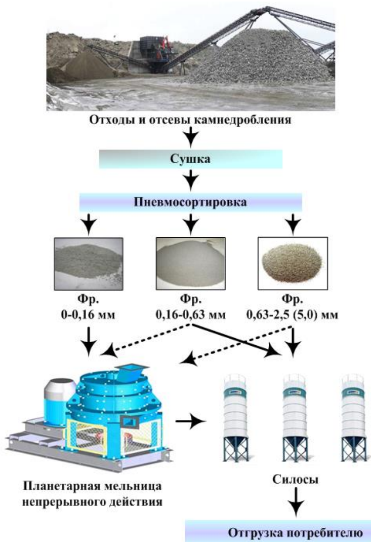
Рис. 6.1. Технологическая схема производства фракционированных наполнителей и заполнителей из отсевов камнедробления
