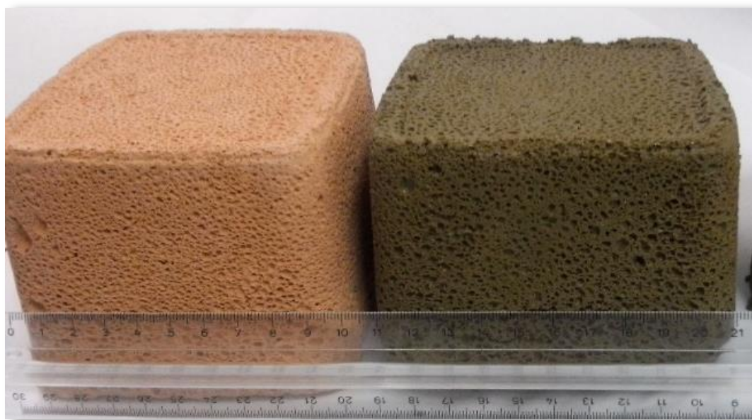
Рисунок 52 – Образцы ячеистого материала из природных силицитов: слева – керамика; справа – сырец
