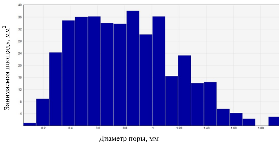
Рисунок 47 – Площадь, занимаемая порами разного размера: а – нижняя часть; б – верхняя часть
