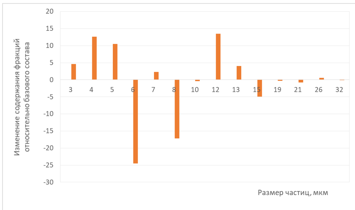
Рисунок 17 – Дифференциальная гистограмма распределения частиц в суспензии с добавкой \text{Na}_2\text{CO}_3 (% от массы): а) 0,5 %; б) 1,0 %; в) 2 %; г) 5 %; д) 10 %
