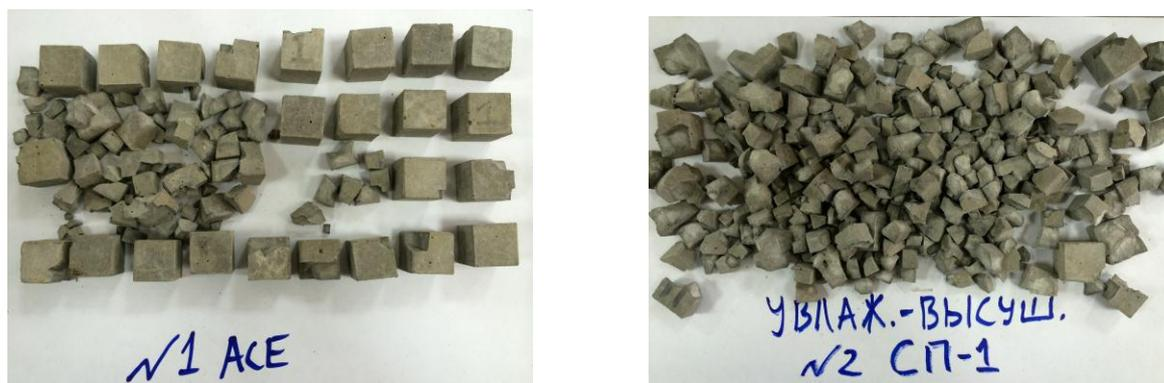
Рисунок 20 – Фотографии образцов цементного камня с добавками АСЕ и СП-1 после циклического увлажнения и высушивания
