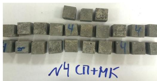
Рисунок 23 – Фотографии образцов цементного камня с добавками АСЕ+МК и СП-1+МК после циклического замораживания и оттаивания
