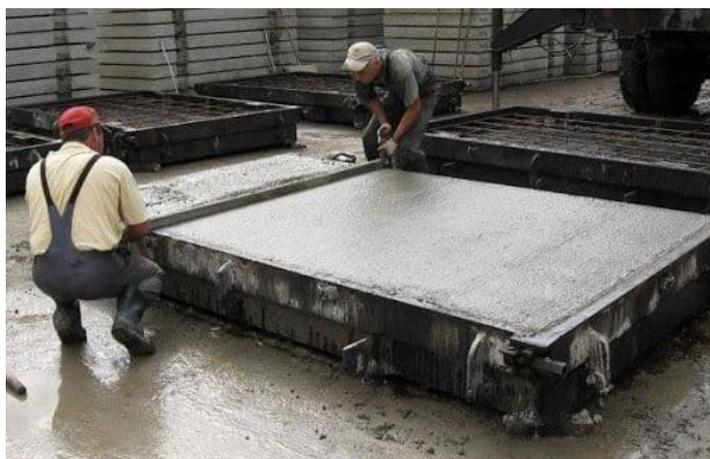
Рисунок 70 – Формование дорожной плиты
