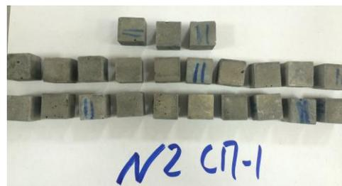
Рисунок 22 – Фотографии образцов цементного камня с добавками АСЕ и СП-1 после циклического замораживания и оттаивания
