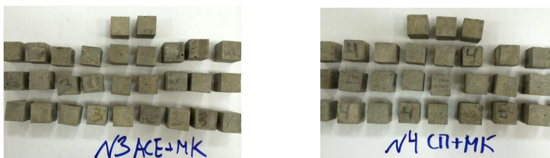
Рисунок 21 – Фотографии образцов цементного камня с добавками АСЕ+МК и СП-1+МК после циклического увлажнения и высушивания
