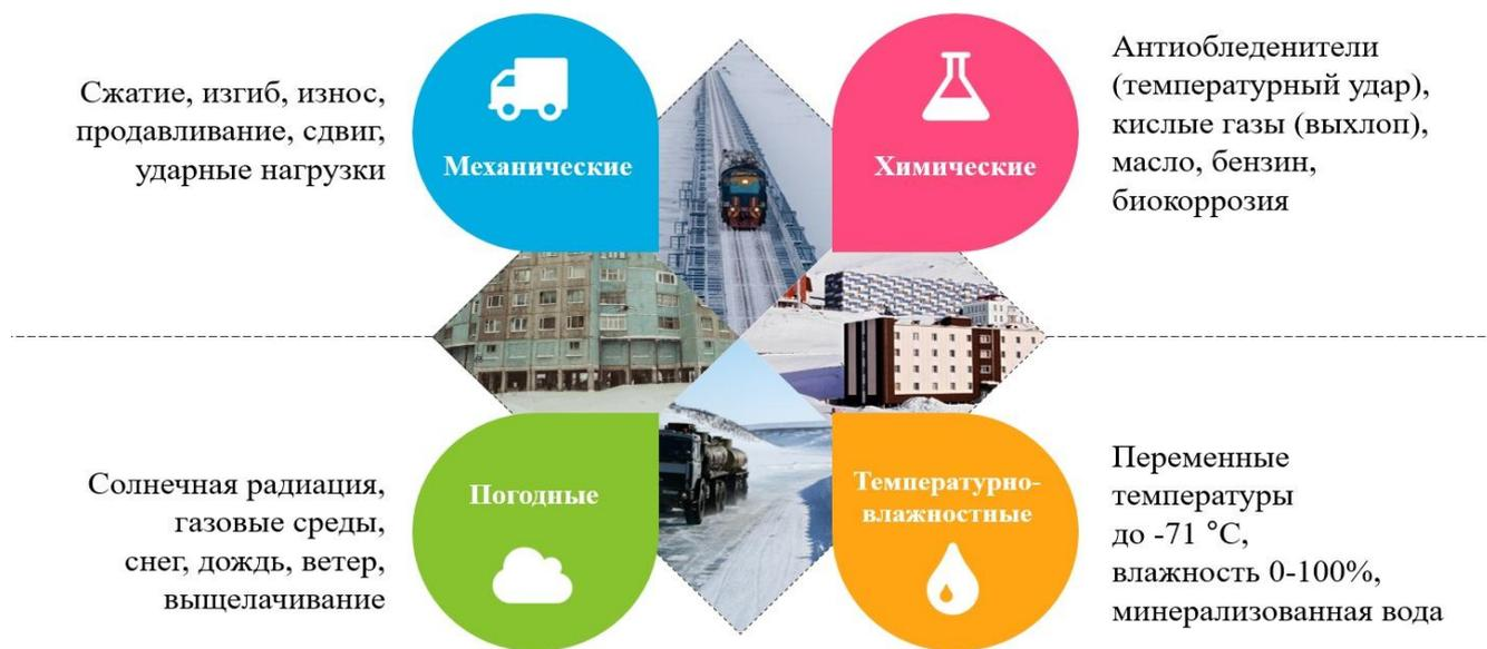
Рисунок 1 – Агрессивные внешние воздействия на бетон в суровых условиях эксплуатации
