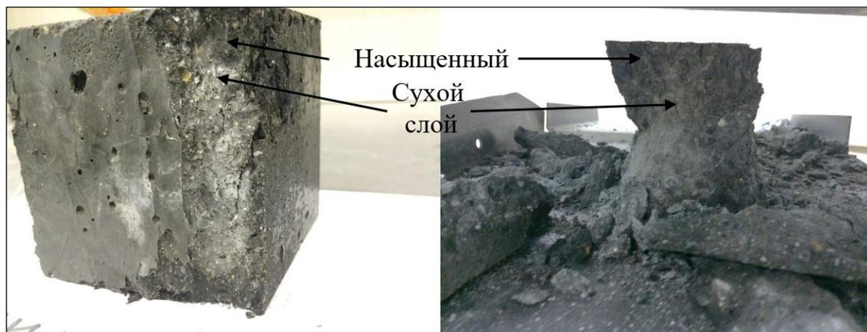
Рисунок 46 – Зоны самовысушивания бетона после 37 циклов замораживания
