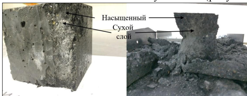
Рисунок 18 – Зоны самовысушивания бетона после 37 циклов замораживания
