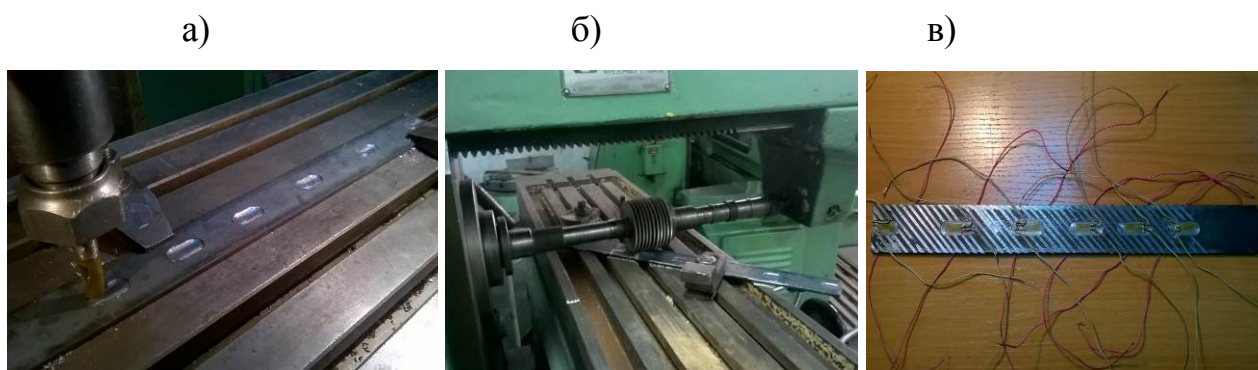
а) фрезерование пазов под тензодатчики; б) фрезерование пазов для увеличения адгезии пластины с клеевой композицией; в) монтаж тензодатчиков
