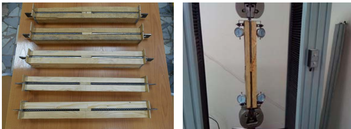
Рисунок 1.25 – Образцы для испытаний, подготовленные для заливки клеем (а) и общий вид испытательной установки (б)
