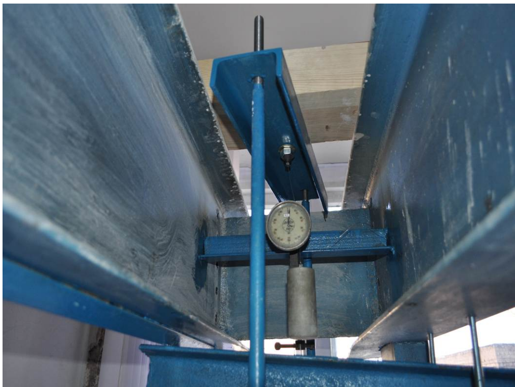
Рисунок 4.21 – Измерение деформаций клеенных пластин относительно массива древесины при помощи индикаторов ИЧ-10
