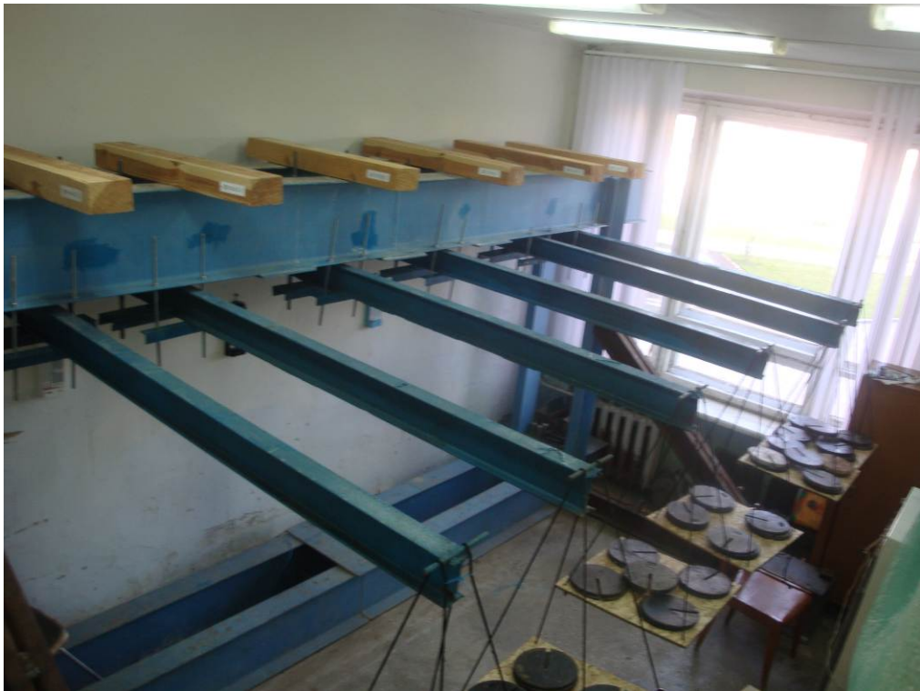
Рисунок 4.20 – Общий вид стенда с рычажной установкой для проведения длительных испытаний
