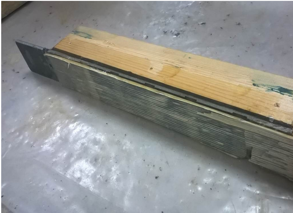
Рисунок 3.8 Характерное разрушение образца скалыванием древесины
