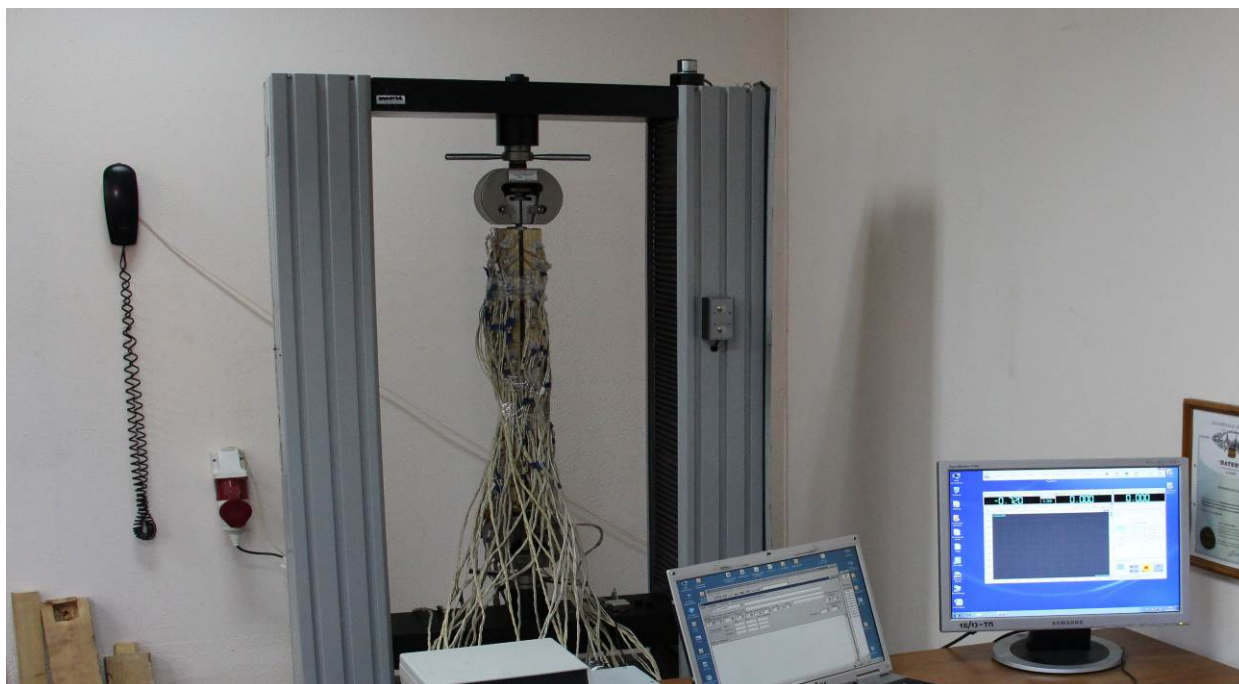
Рис. 3.7 Испытательная установка для изучения НДС соединения
