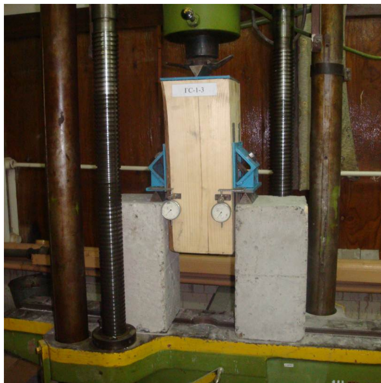
Рисунок 4.27– Общий вид испытания образца с четырьмя параллельно работающими пластинами
