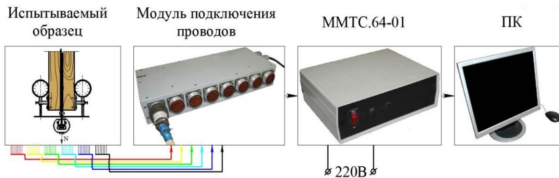
Рис. 5 Схема подключения тензодатчиков
