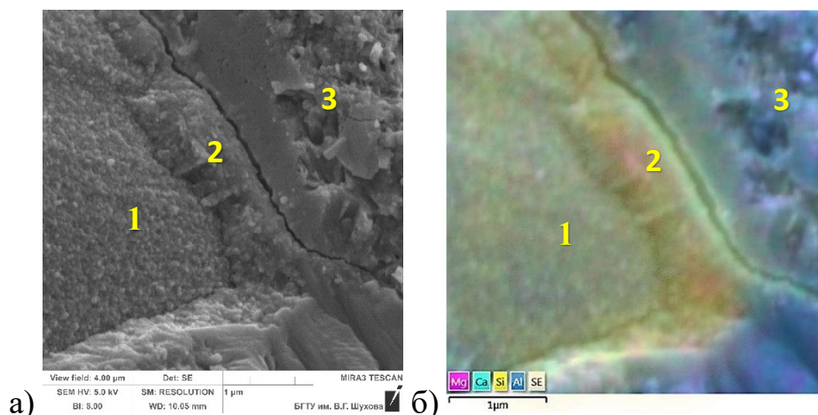
Рисунок 4.5 – Контактная зона стекловолокна с цементным камнем (а) и ее многослойная карта энерго-дисперсионной спектроскопии (б) на 72 сутки испытаний: 1 – стекловолокно, 2 – продукт коррозии, 3 – гидратированное вяжущее
