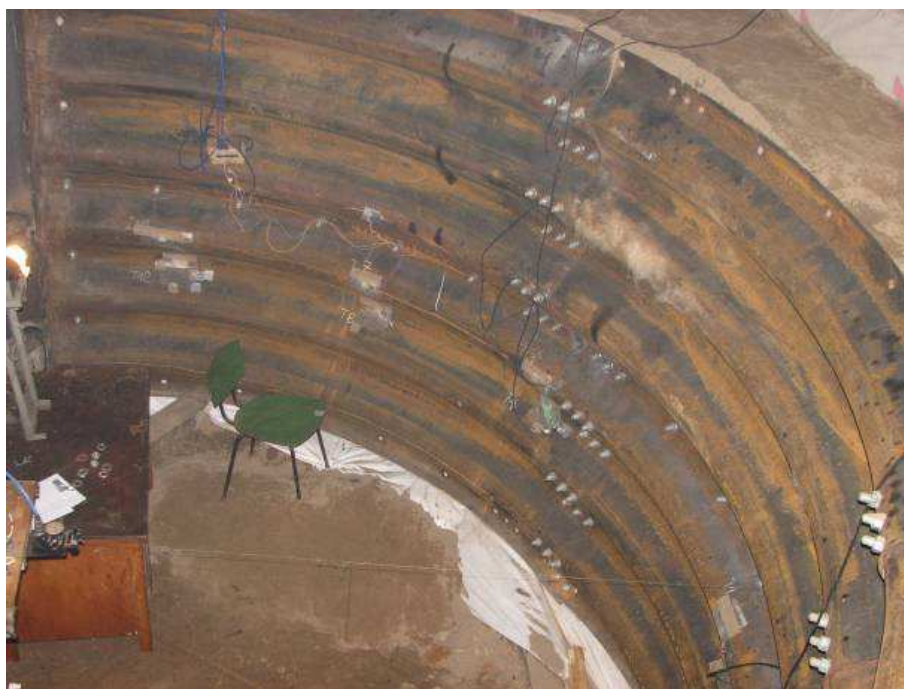
Рисунок 2.20 – Датчики, установленные внутри МГК
