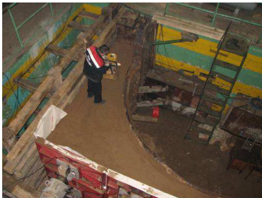
Рисунок 2.18 – Общий вид камеры объемного нагружения и модели МГК
