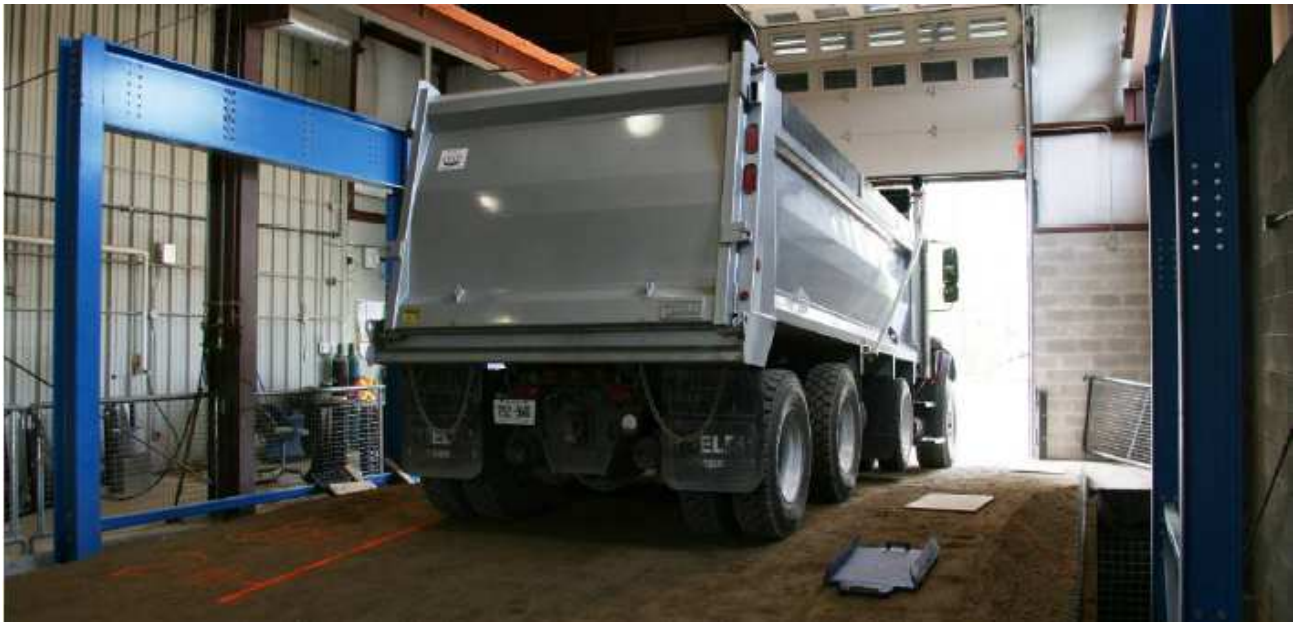
Рисунок 2.8 – Грузовой автомобиль, установленный над сооружением во время испытаний
