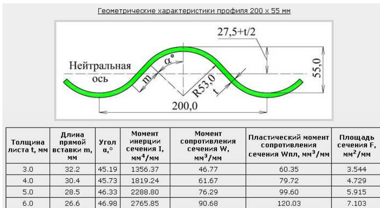
Рисунок 3.7 – Вид и геометрические характеристики гофрированного листа фирмы «Гофросталь»
