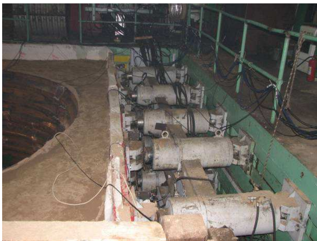
Рисунок 2.22 – Батарея гидродомкратов, имитирующих грунтовое давление
