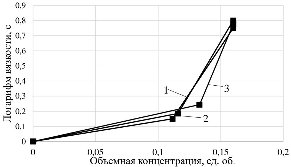
Рисунок 4.5 – Зависимость логарифма вязкости системы от объёмной концентрации пигмента (сурик железный): 1 – жидкое стекло; 2 – полисиликатный раствор; 3 – полисиликатный раствор с глицерином
