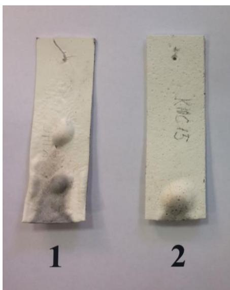
Рисунок 5.17 – Внешний вид образцов после испытаний на горючесть по методу «Огневая труба»: 1 – покрытие на основе силикатной краски; 2 – покрытие на основе золь-силикатной краски
