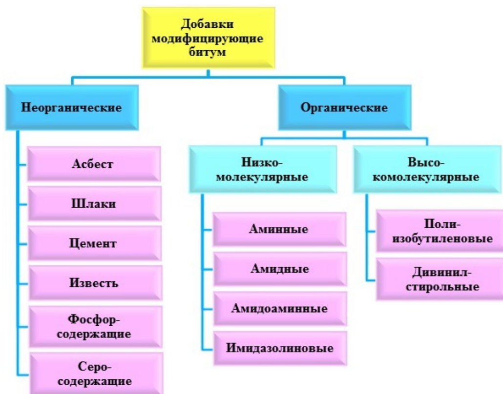
Рисунок 1.5 – Классификация добавок для модификации битума
