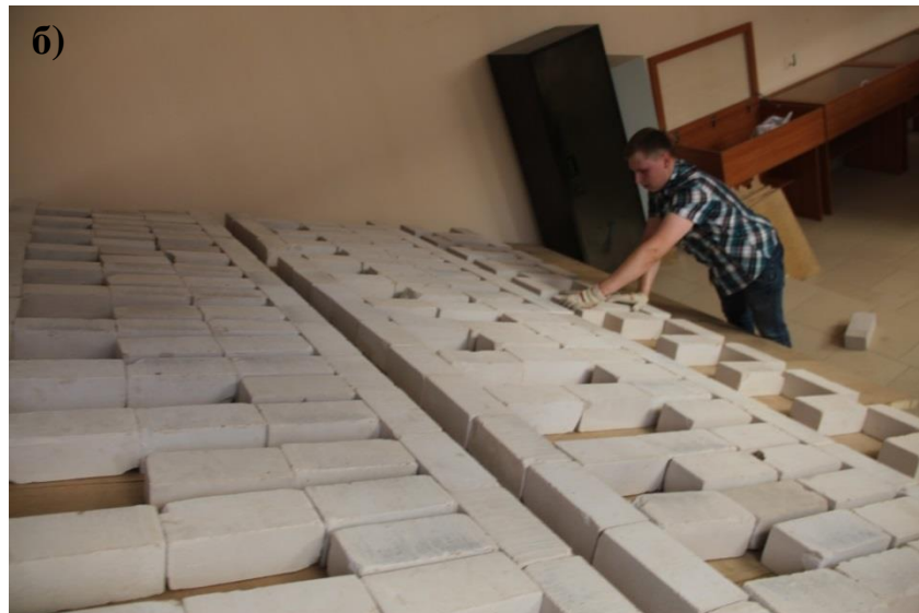
Рисунок 4.12 – Общий вид испытательного стенда (а) и загрузки опытных конструкций (б)
