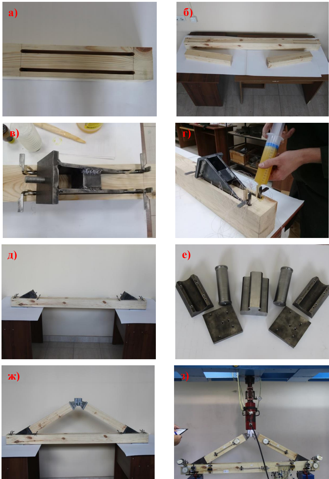
Рисунок 4.6– Этапы сборки образца для испытания опорного узла фермы: а – выполнение пазов в нижнем поясе; б – комплект деревянных деталей; в – установка опорных башмаков; г – процесс вклеивания; д – нижний пояс с опорными башмаками; е – элементы шарнира конькового узла; ж – натурный образец в сборе; з – общий вид образца с приборами
