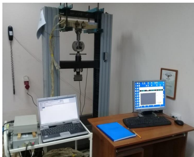
Рисунок 2.26 – Проведение испытаний с тензометрированием
