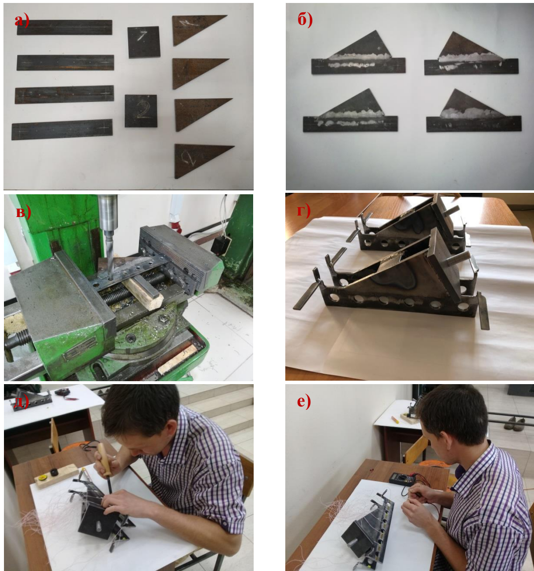
Рисунок 4.3 – Этапы сборки стальной опорной части: а – часть комплекта деталей опорных башмаков; б – подкосы, приваренные к плоским стержням; в – сверление отверстий; г – сваренная конструкция; д – наклейка и распайка тензорезисторов; е – защита и прозванивание тензорезисторов
