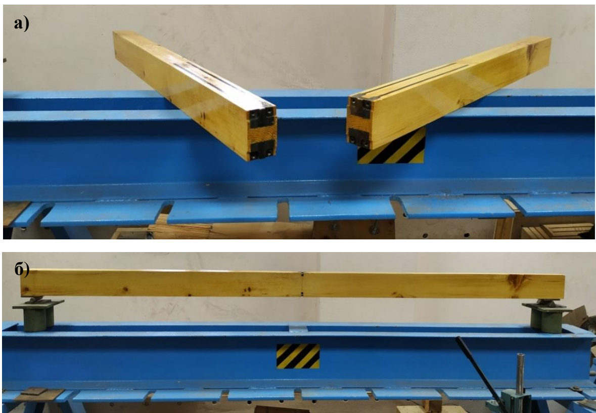
Рисунок 3.8 – Компактное сборно-разборное соединение нижнего пояса (натурная модель): а – два стыкуемых элемента; б – конструкция в сборе
