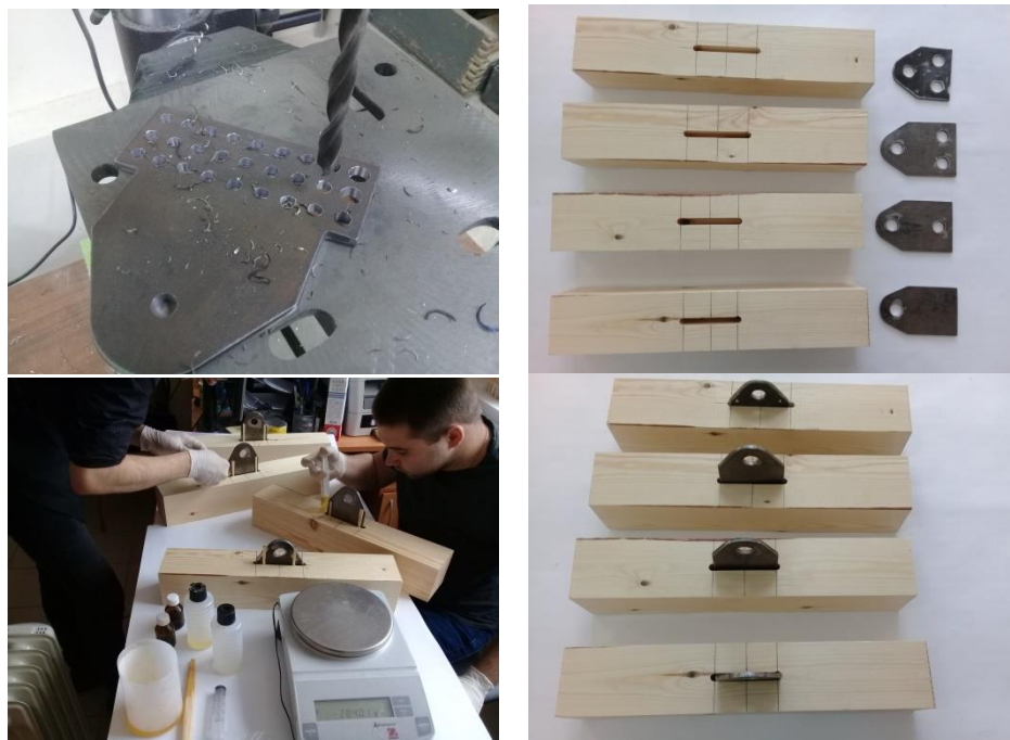
Рисунок 2.13 – Этапы сборки натуральных образцов
