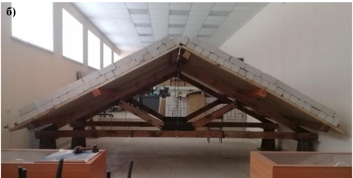
Рисунок 4.11 – Схема фермы с расстановкой измерительных приборов (а) и общий вид конструкции в процессе пробного испытания (б)
