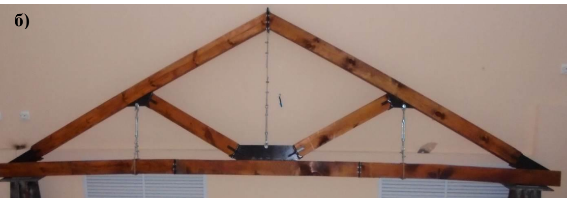
Рисунок 4.9 – Геометрическая схема опытной конструкции и схема её загрузки (а) и общий вид фермы, подготовленной к испытанию (б)
