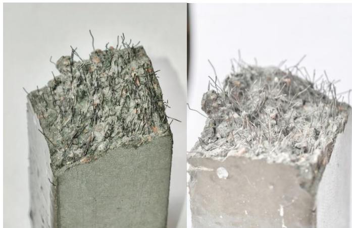
Рисунок 64 – Вид поверхности излома дисперсно-армированного бетона
