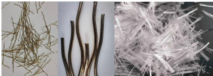
Рисунок 69 – Вид волокон (слева направо): стеклянные, стальные и полимерные
