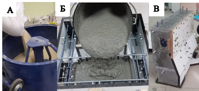
Рисунок 104 – Процесс изготовления станины:
