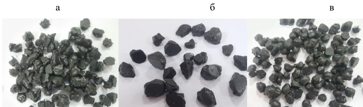
Рисунок 61 – Вид частиц заполнителя с силиконовым покрытием:
