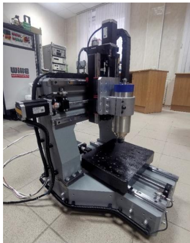
Рисунок 107 – Общий вид фрезерного ЧПУ станка с бетонными несущими элементами
