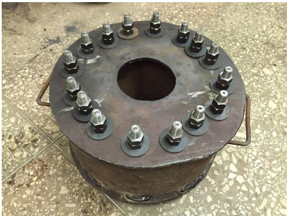
Рисунок 16 – Опытный образец матрицы в сборе
