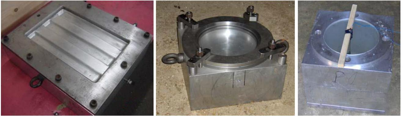
Рисунок 3 – Металлические матрицы для взрывной штамповки
