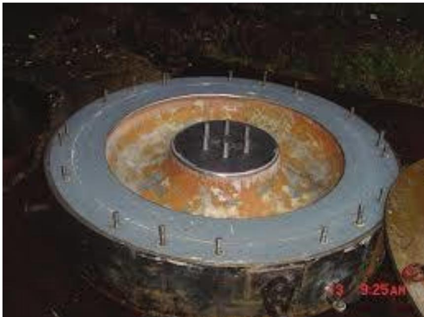
Рисунок 7 – Железобетонная матрица с обрамлением из металла [115]
