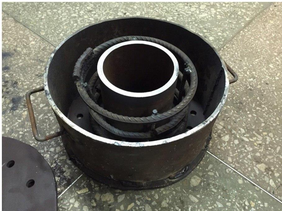
Рисунок 15 – Конструктивные элементы матрицы
