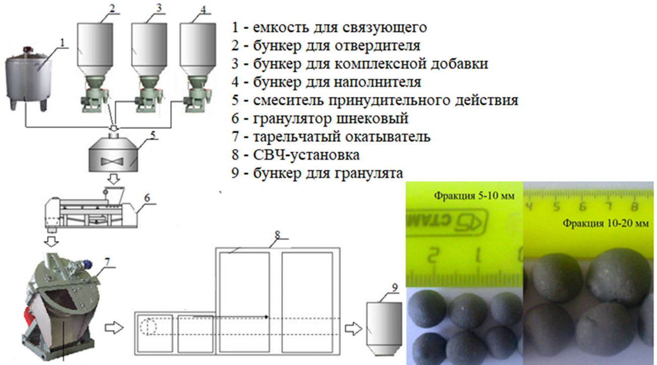
Рисунок 6.1. – Схема экспериментальной технологической линии по изготовлению гранулята
