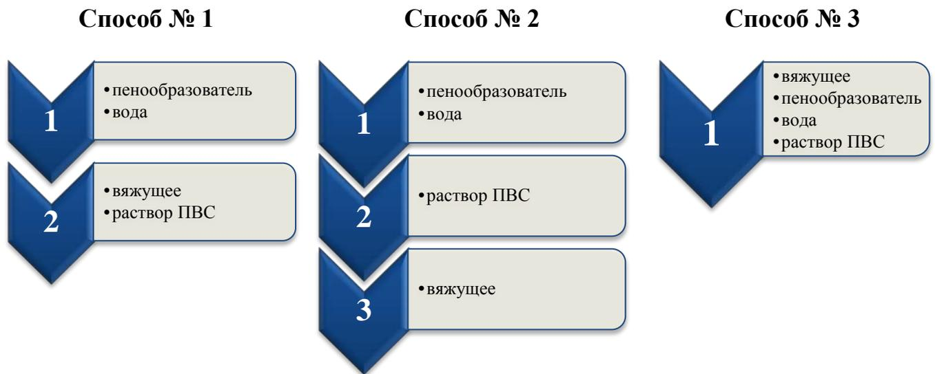
**Рисунок 4.9** – Способы получения пенобетона на основе высококонцентрированной алюмосиликатной вяжущей суспензии
