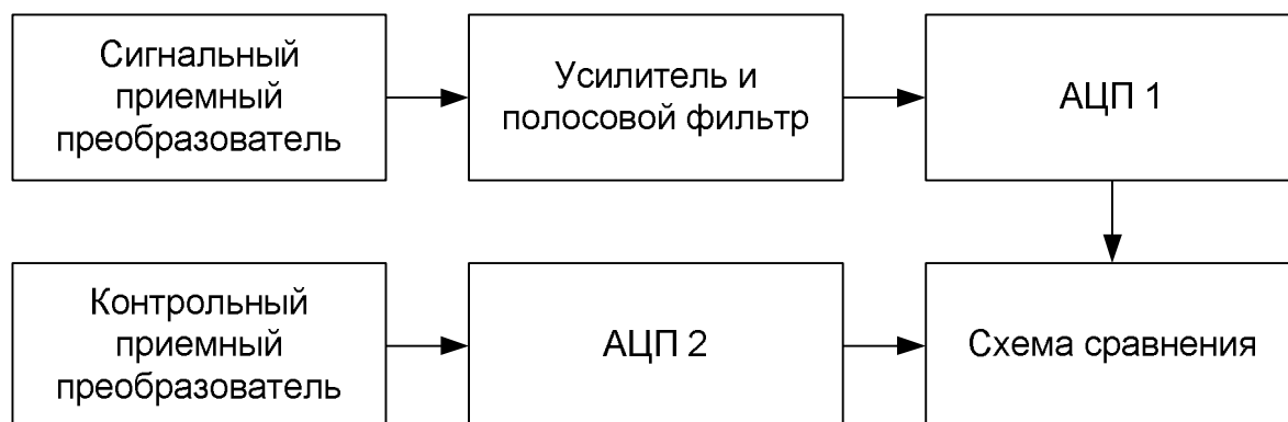
Рисунок 2.5 – Блок-схема устройства регистрации сигналов АЭ
