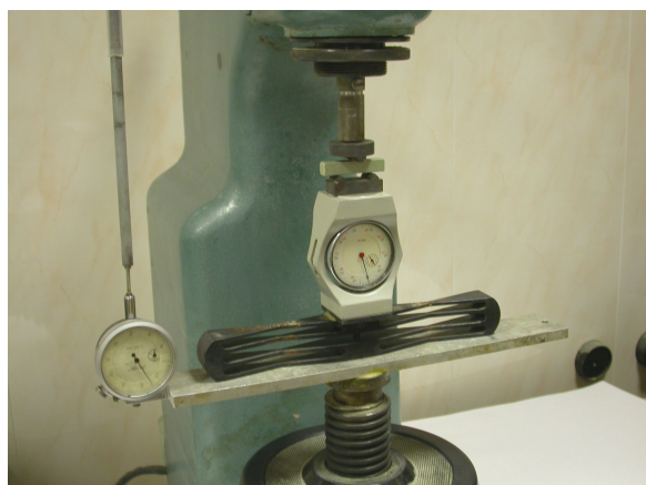
Рисунок 2.4. – Установка для определения предела прочности при изгибе (а) и сжатии (б) для образцов-балок с геометрическими размерами (10 \times 10 \times 50) \cdot 10^{-3} м
