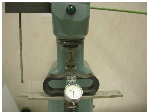
Рисунок 2.4. – Установка для определения предела прочности при изгибе (а) и сжатии (б) для образцов-балок с геометрическими размерами (10 \times 10 \times 50) \cdot 10^{-3} м
