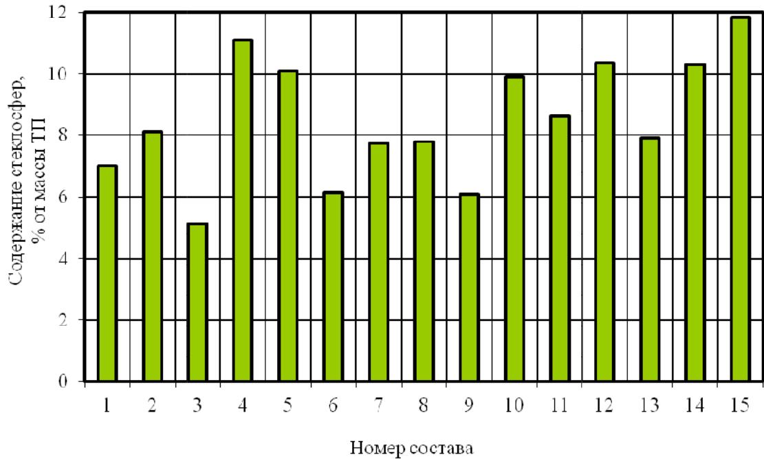
Рисунок 3.3.1 – Содержание полых микросфер марки K15 3M™ в зависимости от массы ТП
