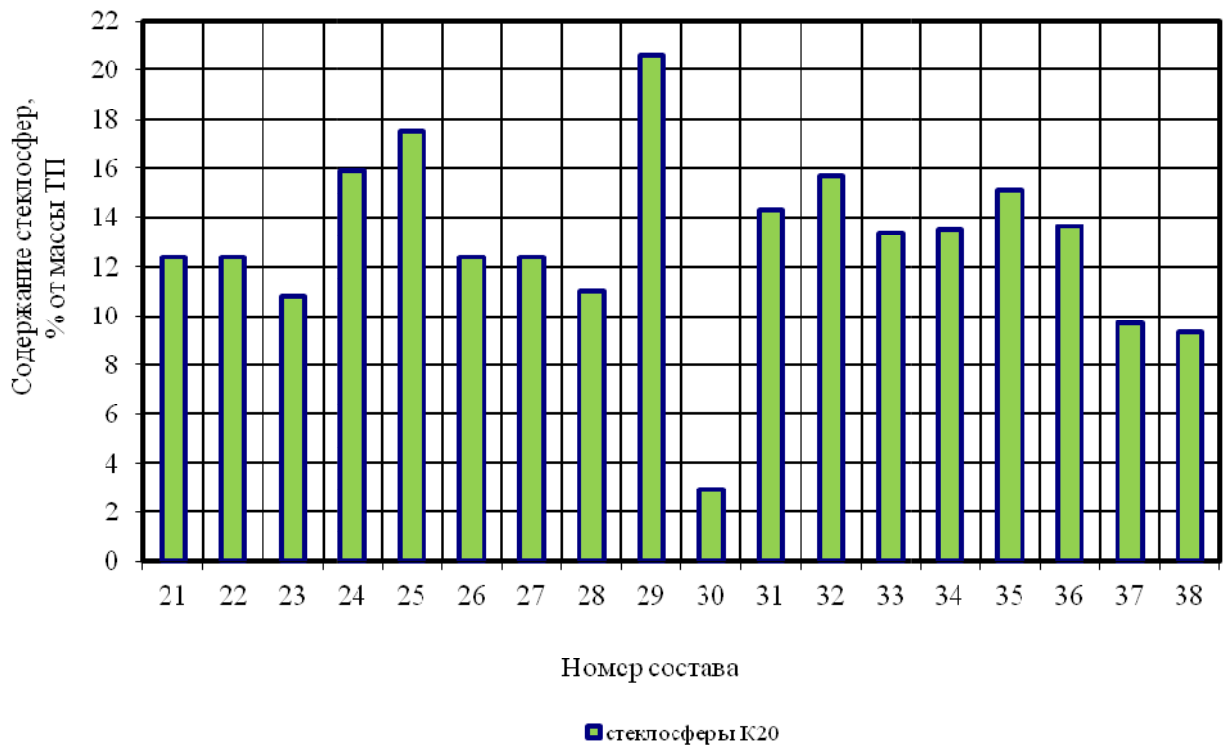
Рисунок 4.1.1 – Гистограммы изменения содержания стеклосфер марки К20 3М™ в составах от массы ТП
