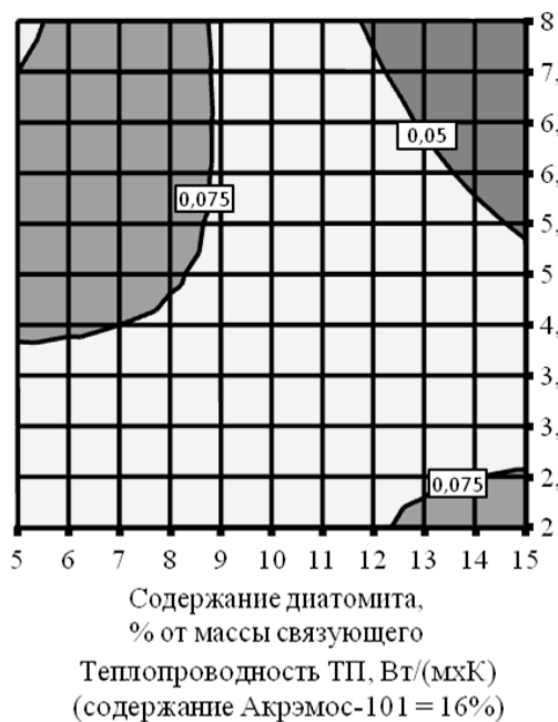
Рисунок 3 – Изолинии изменения теплопроводности ТП в зависимости от содержания диатомита, белой сажи и акриловой дисперсии: а – 16 %; б – 20 %
