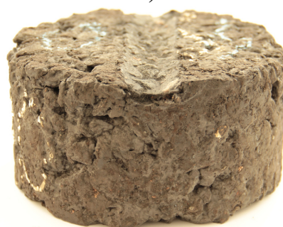
Рисунок 4.2 – Образцы асфальтобетона, испытанные по методу AASHTO TP 63: а) контрольный состав; б) сероасфальтобетон с 20 %-ным содержанием серного модификатора; в) то же, с 30-ным % содержанием серного модификатора; г) то же, с 40 %-ным содержанием серного модификатора
