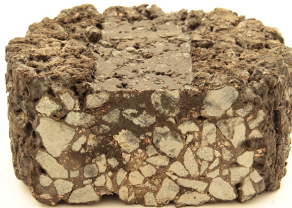
Рисунок 4.6 – Образцы асфальтобетона, испытанные по Гамбургскому тесту: а) контрольный состав; б) сероасфальтобетон с 20 %-ным содержанием серного модификатора; в) то же, с 30 %-ным содержанием серного модификатора; г) то же, с 40 %-ным содержанием серного модификатора
