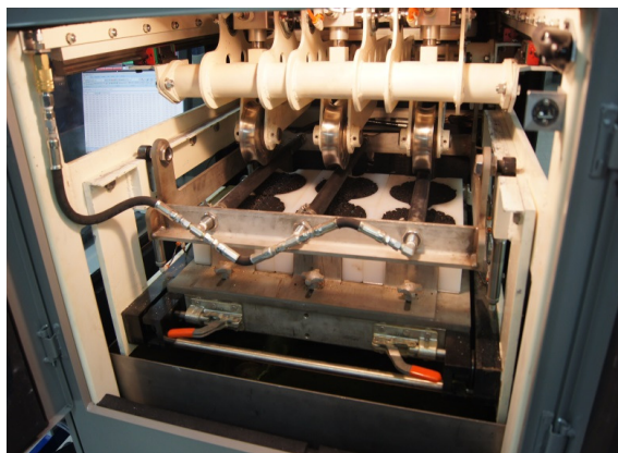
Рисунок 2.1 – Схема нагрузки на образец при тесте по методу АРА
