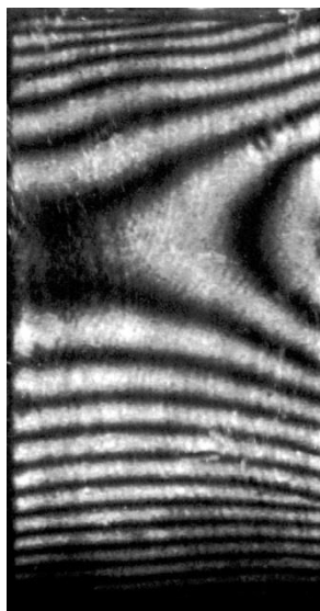
Рисунок 4.9 – Интерферограммы ( a–в, д, ж–и ), 3D-графики ( г, е ) деформаций поверхности фотографии ( к ) образца состава № 5 ( \Delta\sigma = 1,53 МПа, другие пояснения приведены в тексте) (начало)
