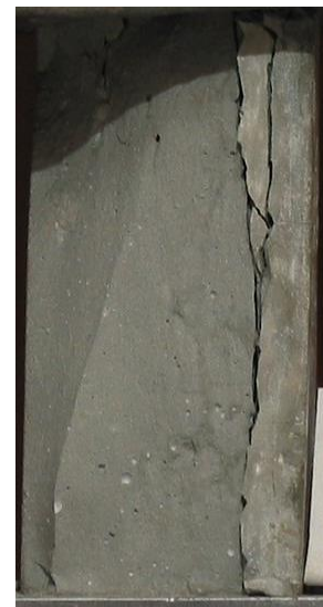
Рисунок 4.11 – Интерферограммы (а, в, г, д), 3D-график (б) деформаций поверхности и фотография (е) разрушения образца состава № Т17 (тестирующий перепад напряжений \Delta\sigma = 1,53 МПа, другие пояснения приведены в тексте)
