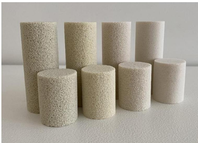
Рисунок 5.5 – Фото образцов, подготовленных для испытания в импедансной трубе
