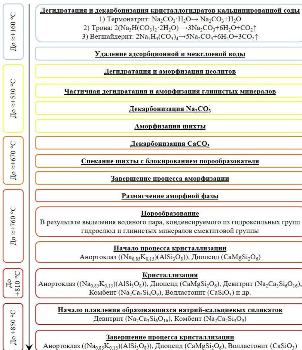
Рисунок 3.16 – Процессы, происходящие в шихте при нагревании
