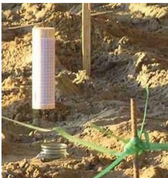
Рис. 4.8 – Размещение шкаловых марок для контроля вертикальных перемещений
