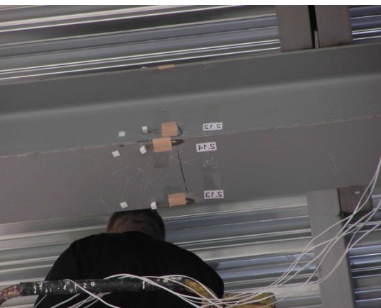
Рис. 4.7 - Тензометрические преобразователи на испытуемых элементах
