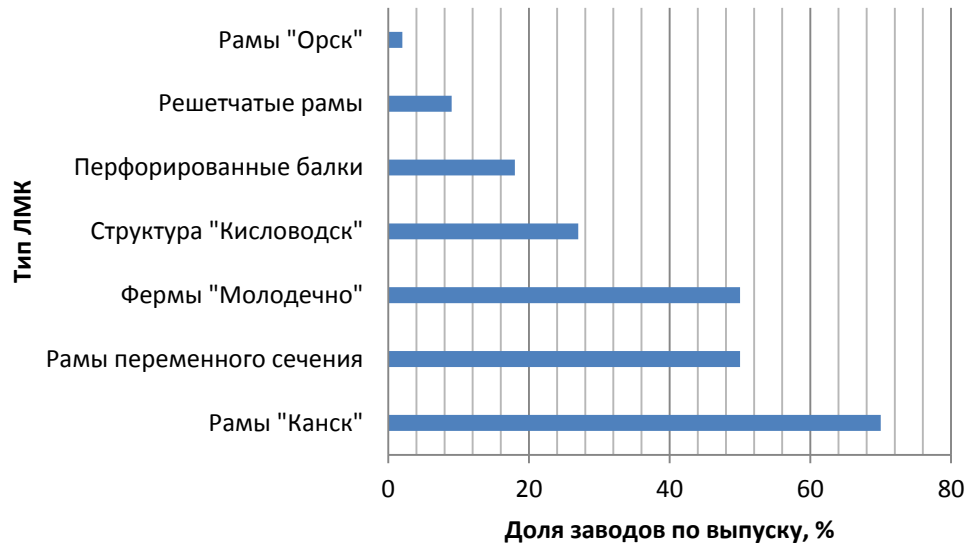
Рис. 1.7 – Выпуск ЛМК заводами металлоконструкций
