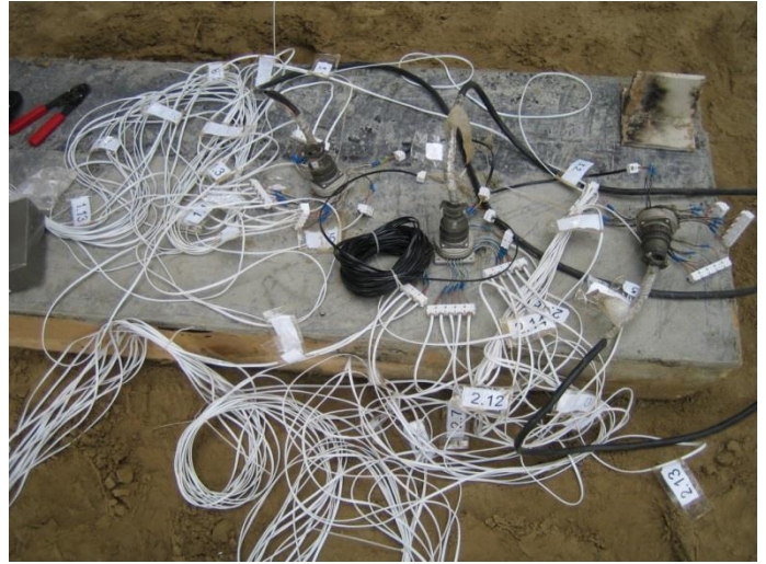
Рис. 4.4 – Оборудование для регистрации относительных деформаций
