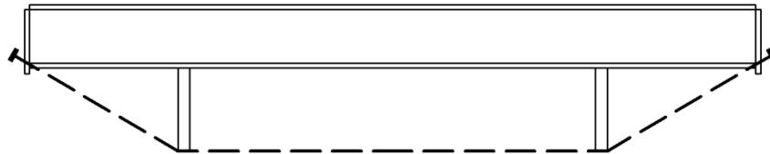
Рис. 1.21 – Предварительно напряженная балка со шпренгельной затяжкой
