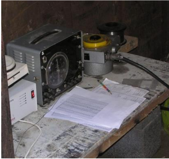
Рис. 4.4 – Оборудование для регистрации относительных деформаций
