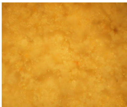
Рис. 3.30 Микроснимки поверхности модифицированного диатомита: а) диатомит, модифицированный 1% раствором КМЦ и прокаленный в атмосфере воздуха; б) диатомит, модифицированный 1% раствором КМЦ и прокаленный в атмосфере азота; в) диатомит, модифицированный 1% раствором КМЦ и последовательно прокаленный в атмосфере азота и воздуха.
