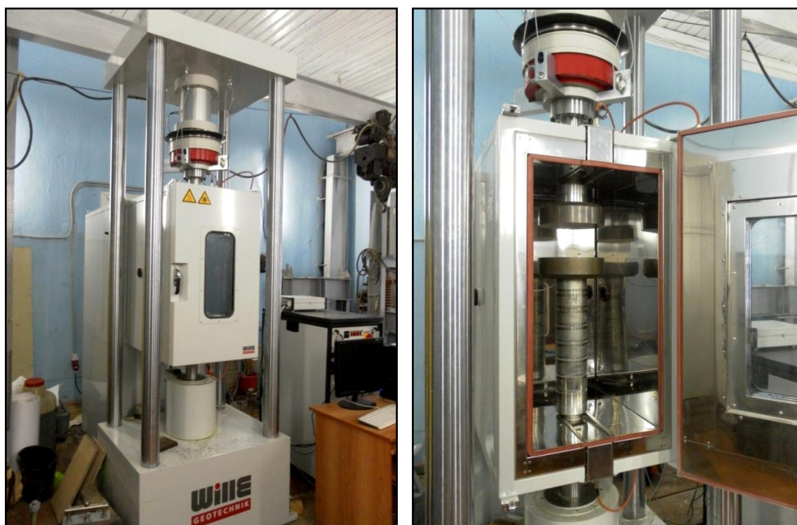
Рис. 3.2.1. Установка WilleGeotechnik® (модель 13-PD/401) с климатической камерой в составе
