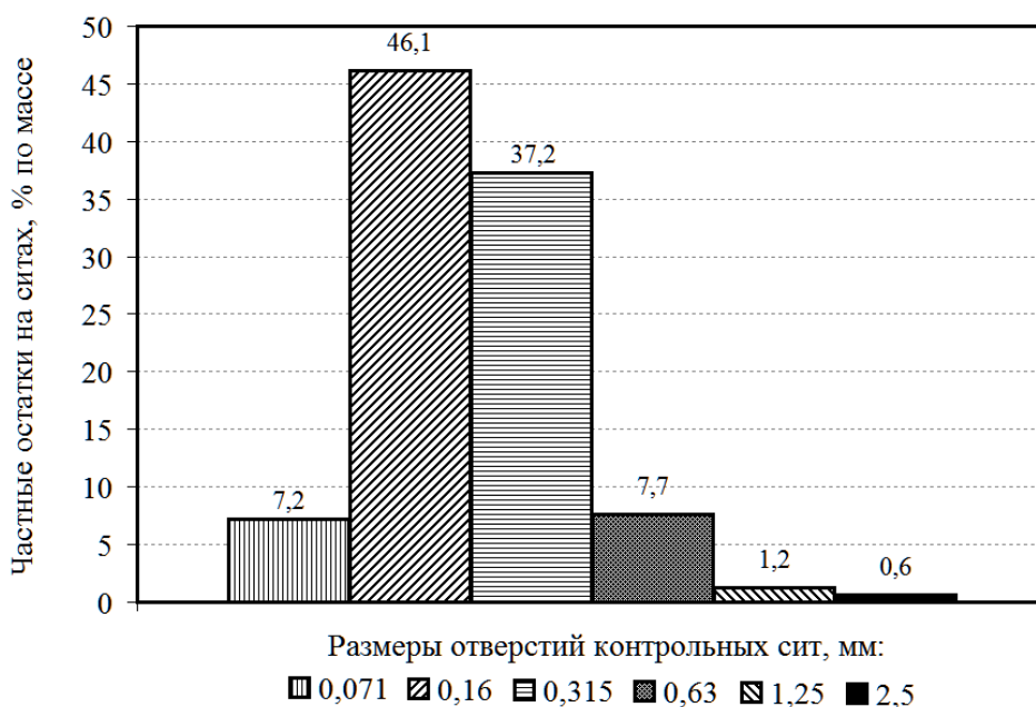
Рис. 2.1.1. График распределения частных остатков на ситах
