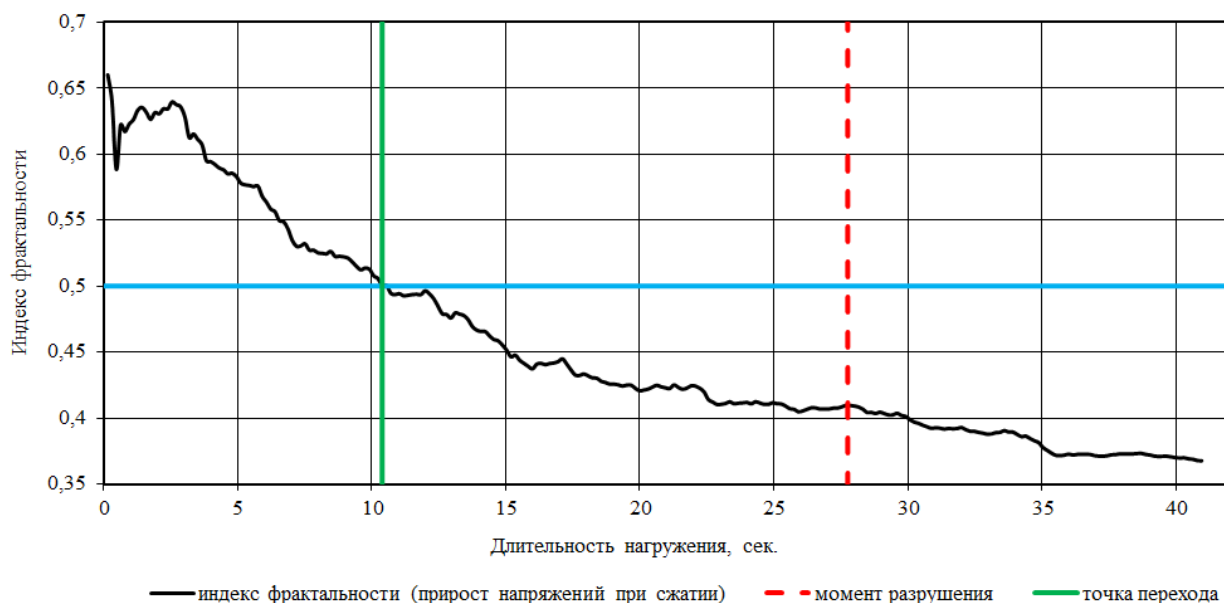
Рис. 3.3.3. Изменение индекса фрактальности прироста напряжений в зависимости от длительности нагружения (вертикальная штриховая линия – время разрушения образца; вертикальная сплошная линия – точка перехода состояния образца в промежуточное состояние между «флэтом» и «трендом»; горизонтальная линия – \mu = 0,5 )
