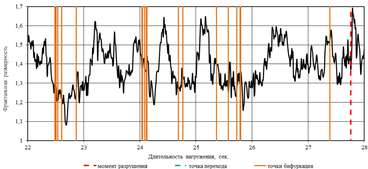
Рис. 3.4.5. Анализ изменения фрактальной размерности (прирост напряжений при сжатии) с учетом расположения точек бифуркации (вертикальные сплошные линии) в зависимости от длительности нагружения
