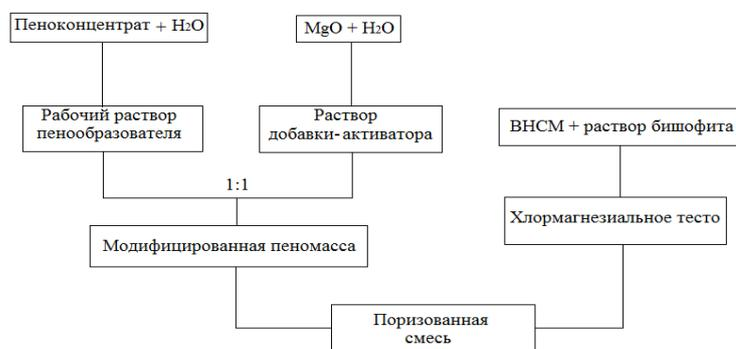
Рисунок 5.1 – Схема подготовки поризованной хлормagneзиальной смеси
