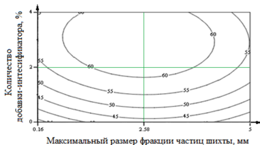
Рисунок 5 – Зависимость прочности магнелиального камня от фракции обжигаемой шихты и количества добавки-интенсификатора (в возрасте 28-ми суток), МПа
