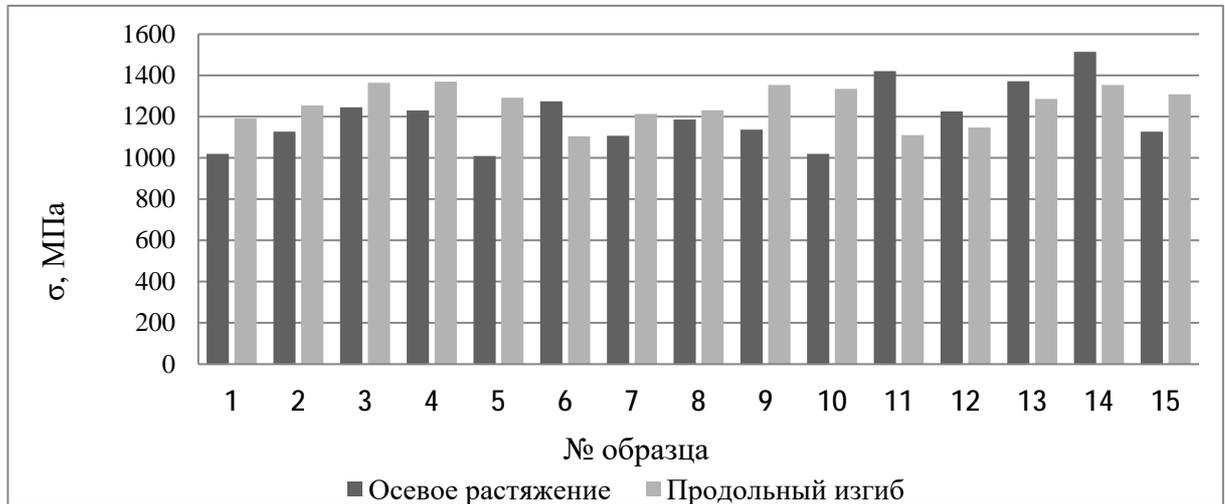
Рисунок 2.7 – Прочностные показатели  $\sigma$  при испытании методом продольного изгиба и при осевом растяжении
