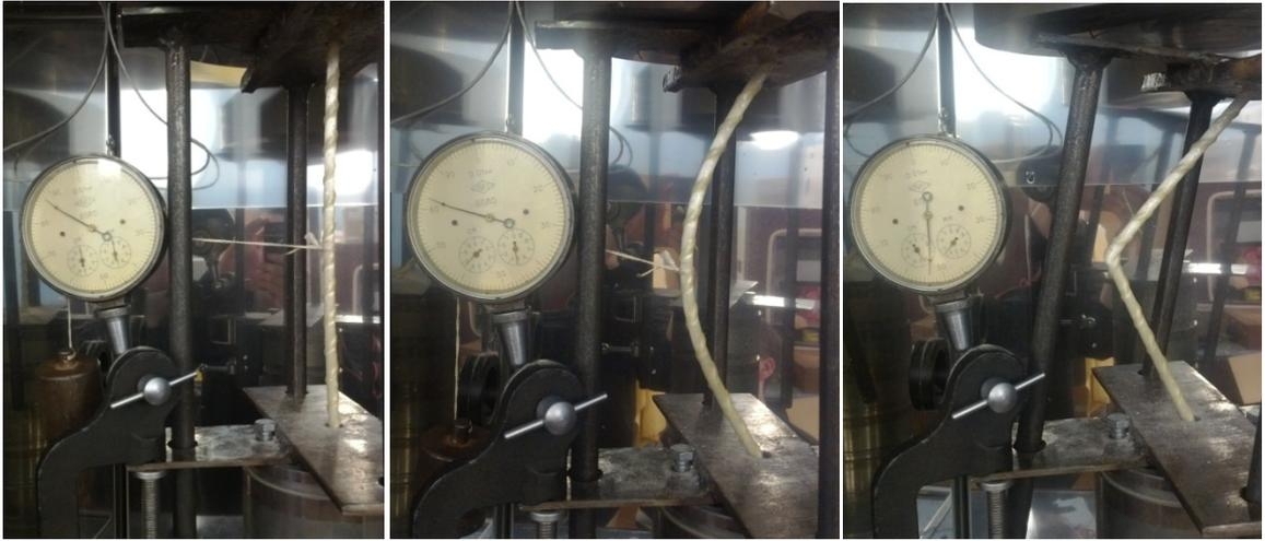
Рисунок 2.4 – Испытания по определению экспериментального значения стрелы выгиба ( $f_{\text{эскп}}$ )
