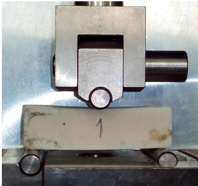
Рисунок 2.12 – Общий вид испытания образца  $20 \times 20 \times 70$  мм на прессе Wille geotechnik 13 DP/401
