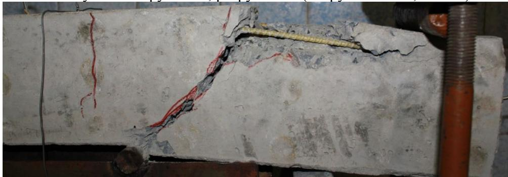
Рисунок Г.11 – Схема развития трещин балки С-2 на разных ступенях нагружения
