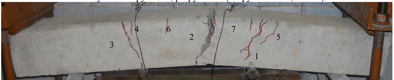
Рисунок Г.14 – Схема развития трещин балки М-4 на разных ступенях нагружения
