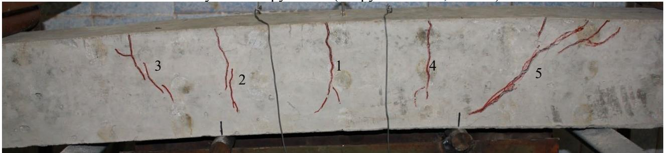
6-я ступень нагружения, разрушение (нагрузка  $2F=18,515$  кН)
