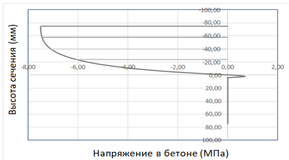
Рисунок 4.5 – Распределение напряжений в бетоне по сечению
