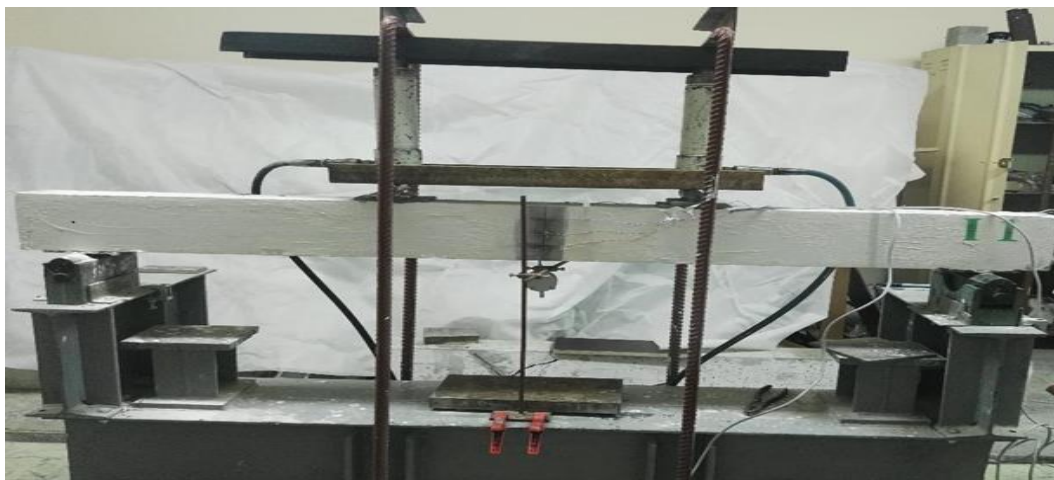
Рисунок 2.33 – Балка №1 до испытаний
