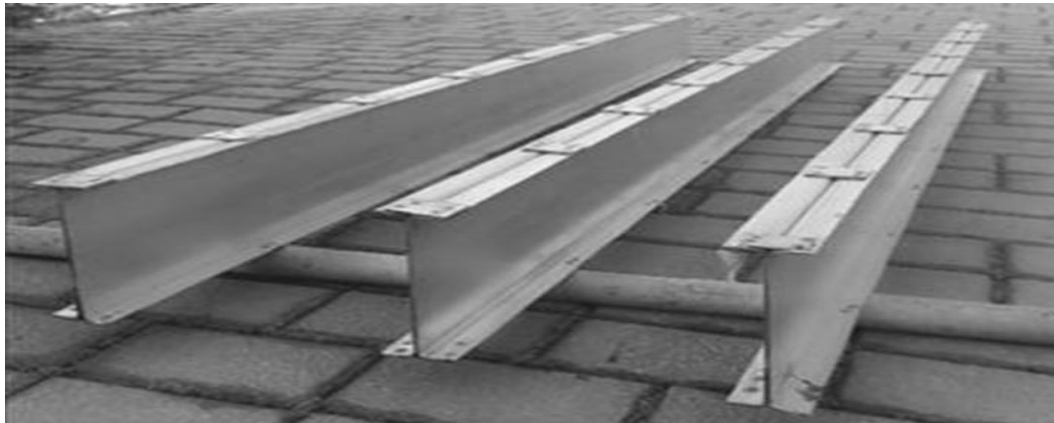
Рисунок 2.32 – Жёсткая арматура из неперфорированных ЛСТК в виде двутавра
