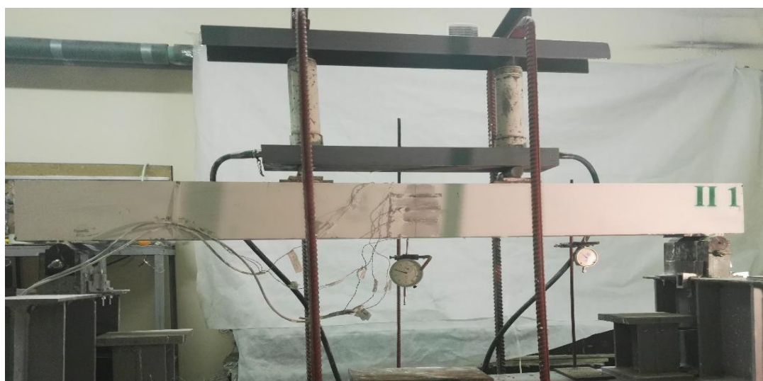
Рисунок 2.45 – Балка №1 до испытаний
